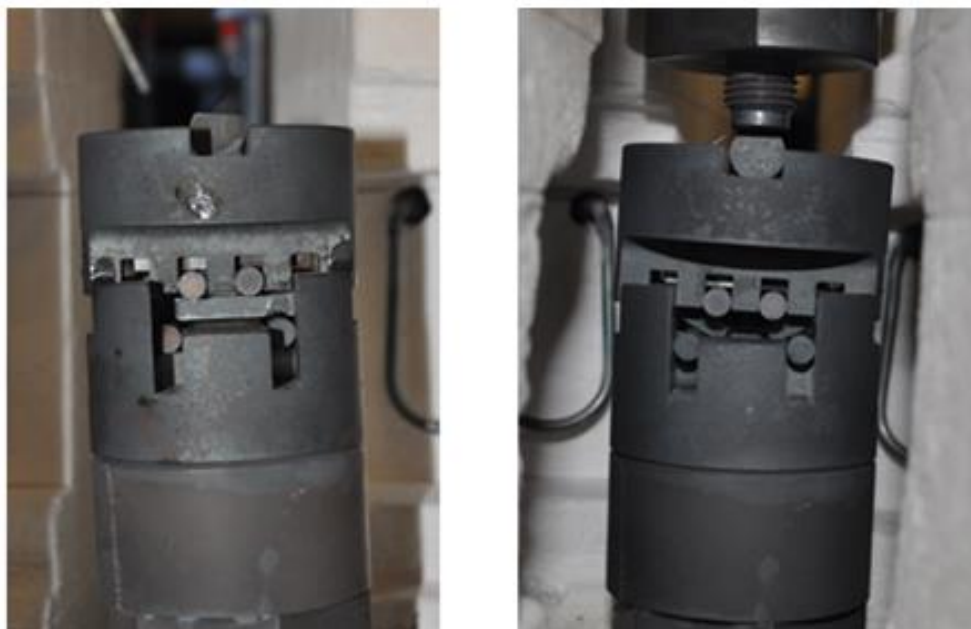
Figura 41. Mordaza móvil para la sujeción de barras en el ensayos de flexión en 4 puntos (tramo 20-10mm) instalada sobre máquina de ensayo electro-mecánico Instron modelo 5505 .
