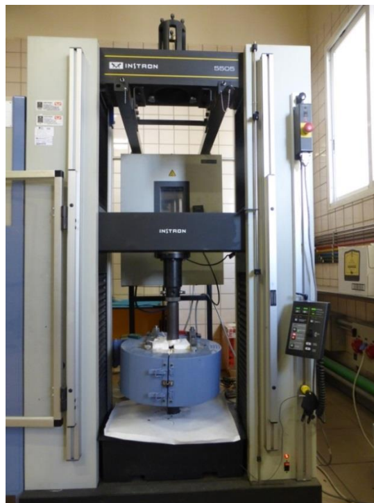
Figura 40. Máquina de ensayo electro-mecánico Instron modelo 5505 .
