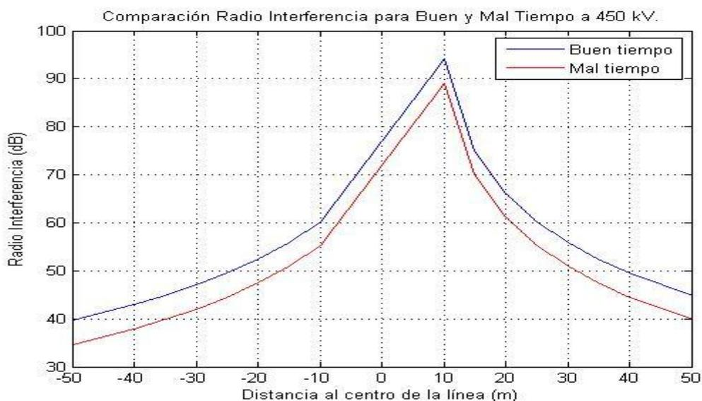
**Figura 4. Comparación de la radio interferencia según las condiciones climatológicas para la línea de  $\pm 450$  kV.**
