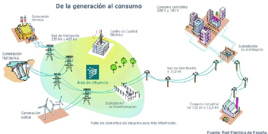
Figura 1. Esquema del sistema eléctrico español
