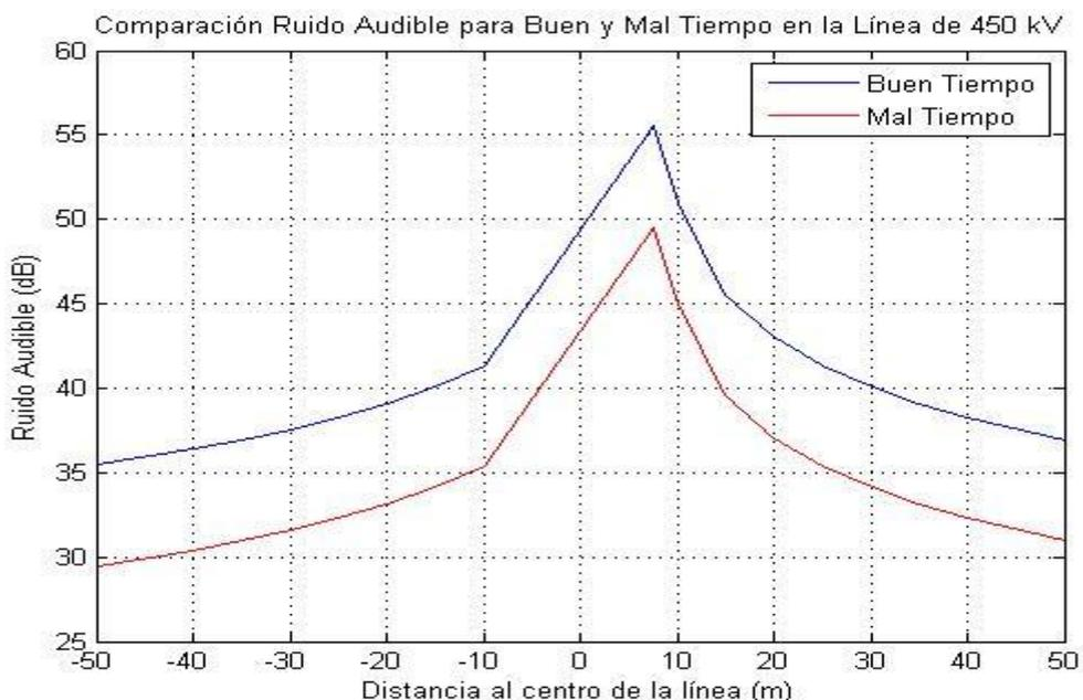
Figura 7. Comparación de las distribuciones del ruido audible para buen y mal tiempo en la línea de  $\pm 450$  kV.
