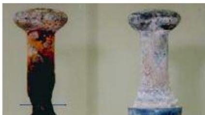
Figura 3. Comparación sujeciones de aisladores sin y con manguitos de zinc. Fuente: Cigré.
