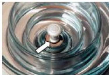
**Figura 89. Aislador HVDC con manguito de zinc. Fuente: Cigeé.**
