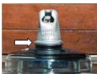
Figura 1. Aislador HVDC con manguito de zinc. Fuente: Cigré.
