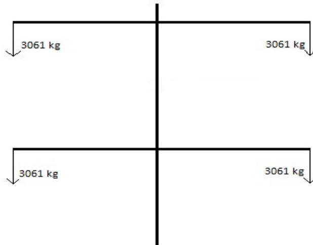
**Figura 97. Árbol de carga para la línea DC sin la acción del viento.**
