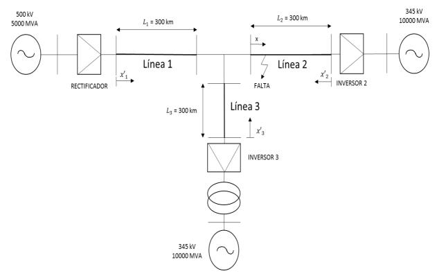
Figura 3.1 Diagrama de red HVDC con 3 líneas de transmisión que enlazan 3 sistemas eléctricos.
