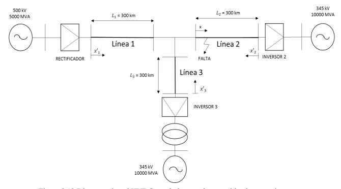
Figura 3.13 Diagrama de red HVDC con 3 sistemas intercambiando potencia
