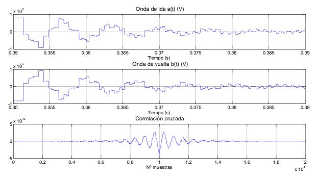
Figura 3.5 Ondas medidas por el inversor 2: a) Onda de vuelta desde la falta hasta el rectificador  $a_2(t)$ . b) Onda de ida desde la falta hasta el inversor 2  $b_2(t)$ . c) Correlación cruzada entre  $a_2(t)$  y  $b_2(t)$ .
