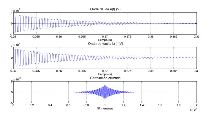
Figura 3.11 Ondas medidas por el inversor 3: a) Onda de vuelta desde la falta hasta el rectificador  $a_3(t)$ . b) Onda de ida desde la falta hasta el inversor 3  $b_3(t)$ . c) Correlación cruzada entre  $a_3(t)$  y  $b_3(t)$ .
