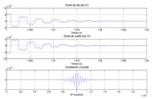
Figura 2.7 Ondas medidas por el inversor: a) Onda de vuelta desde la falta hasta el inversor  $a_2(t)$ . b) Onda de ida desde la falta hasta el rectificador  $b_2(t)$ . c) Correlación cruzada entre  $a_2(t)$  y  $b_2(t)$
