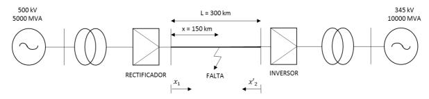
Figura 2.2 Esquema del sistema para una falta en x = 150 km y resistencia de falta  $R_f = 0$
