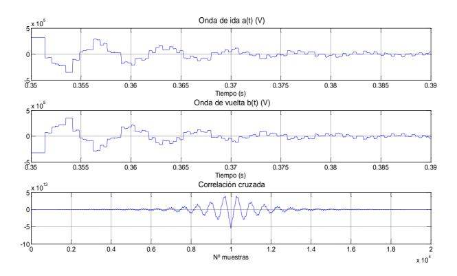
Figura 3.17 Ondas medidas por el inversor 3: a) Onda de vuelta desde la falta hasta el rectificador  $a_3(t)$ . b) Onda de ida desde la falta hasta el inversor 3  $b_3(t)$ . c) Correlación cruzada entre  $a_3(t)$  y  $b_3(t)$ .
