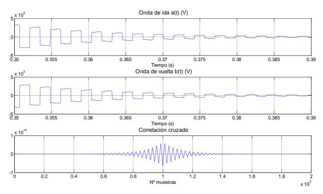
Figura 3.16 Ondas medidas por el inversor 2: a) Onda de vuelta desde la falta hasta el rectificador  $a_2(t)$ . b) Onda de ida desde la falta hasta el inversor 2  $b_2(t)$ . c) Correlación cruzada entre  $a_2(t)$  y  $b_2(t)$ .
