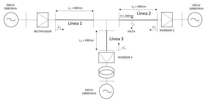
Figura 3.14 Falta en la línea 2 con x=100 km y  $R_f=0~\Omega$
