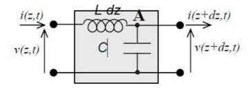
Figura 1.2 Modelo diferencial de línea de transmisión sin pérdidas.
