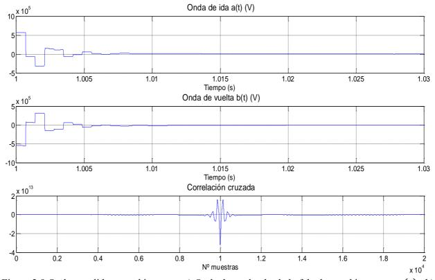
Figura 2.9 Ondas medidas por el inversor: a) Onda de vuelta desde la falta hasta el inversor  $a_2(t)$ . b) Onda de ida desde la falta hasta el rectificador  $b_2(t)$ . c) Correlación cruzada entre  $a_2(t)$  y  $b_2(t)$
