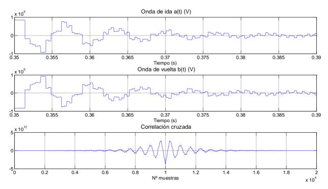
Figura 3.6 Ondas medidas por el inversor 3: a) Onda de vuelta desde la falta hasta el rectificador  $a_3(t)$ . b) Onda de ida desde la falta hasta el inversor 3  $b_3(t)$ . c) Correlación cruzada entre  $a_3(t)$  y  $b_3(t)$ .
