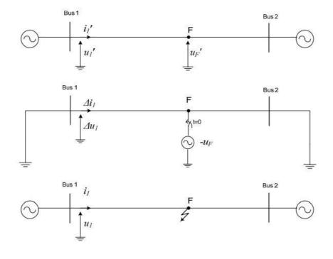
Figura 1.5 Superposición de tensión y corriente en una falta.
