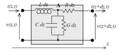
Figura 1.3 Modelo diferencial de línea de trasmisión con pérdidas.
