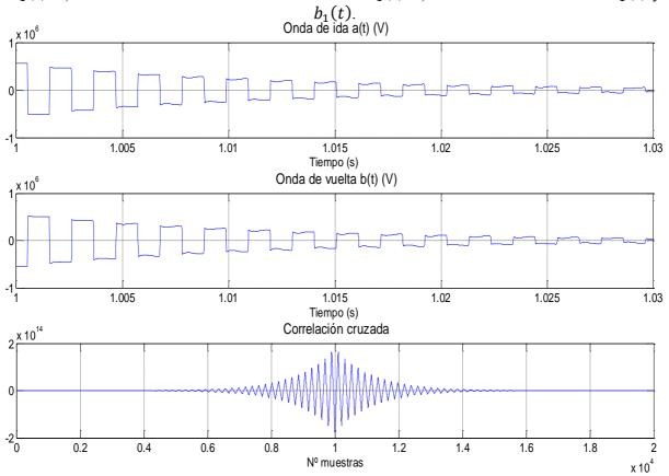
Figura 2.4 Ondas medidas por el inversor: a) Onda de vuelta desde la falta hasta el inversor  $a_2(t)$ . b) Onda de ida desde la falta hasta el rectificador  $b_2(t)$ . c) Correlación cruzada entre  $a_2(t)$  y  $b_2(t)$  Como puede observarse las señales medidas desde rectificador e inversor son casi idénticas e incluso
