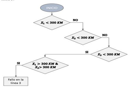
Figura 3.12 Diagrama de flujo para fallo en línea 3
