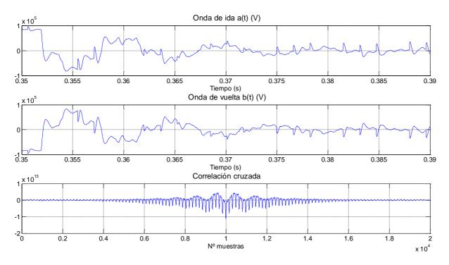
Figura 3.9 Ondas medidas por el rectificador: a) Onda de vuelta desde la falta hasta el rectificador  $a_1(t)$ . b) Onda de ida desde la falta hasta el inversor  $b_1(t)$ . c) Correlación cruzada entre  $a_1(t)$  y  $b_1(t)$ .
