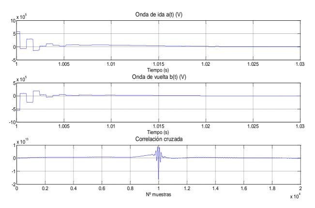
Figura 2.8 Ondas medidas por el rectificador: a) Onda de vuelta desde la falta hasta el rectificador  $a_1(t)$ . b) Onda de ida desde la falta hasta el inversor  $b_1(t)$ . c) Correlación cruzada entre  $a_1(t)$  y  $b_1(t)$ .
