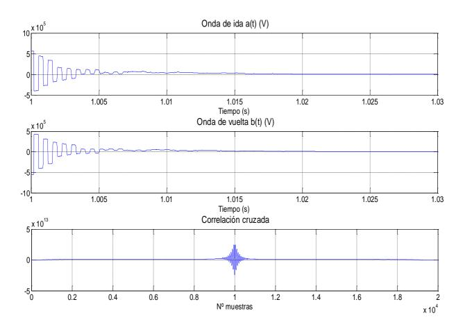
Figura 2.6 Ondas medidas por el rectificador: a) Onda de vuelta desde la falta hasta el rectificador  $a_1(t)$ . b) Onda de ida desde la falta hasta el inversor  $b_1(t)$ . c) Correlación cruzada entre  $a_1(t)$  y  $b_1(t)$ .
