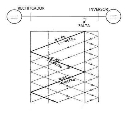
Figura 1.6 Esquema de falta en una línea que conecta dos generadores.
