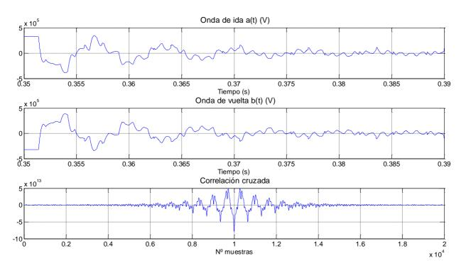
Figura 3.15 Ondas medidas por el rectificador: a) Onda de vuelta desde la falta hasta el rectificador  $a_1(t)$ . b) Onda de ida desde la falta hasta el inversor  $b_1(t)$ . c) Correlación cruzada entre  $a_1(t)$  y  $b_1(t)$ .
