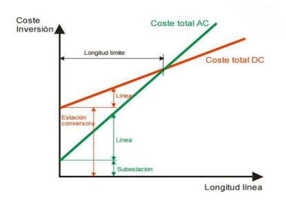
Figura 0.3 Pérdida/Distancia de transmisión en líneas de transmisión.
