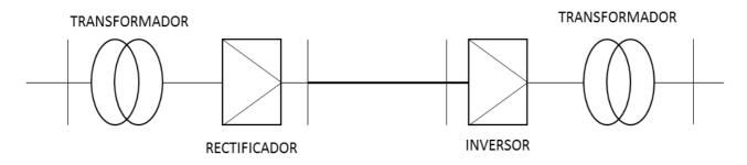
Figura 0.1 Sistema de transmisión de energía HVDC
