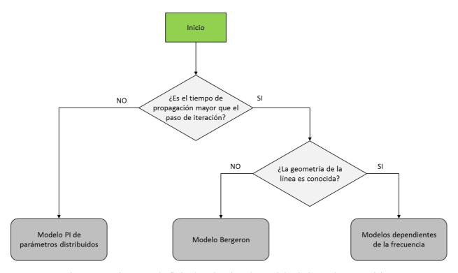
Figura 1.1 Diagrama de flujo de selección de modelo de línea de transmisión
