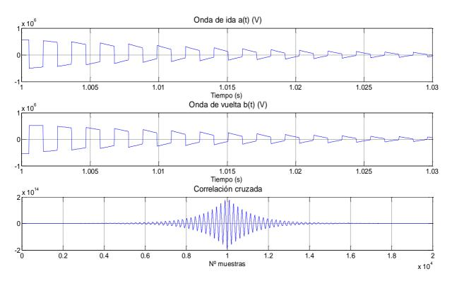
Figura 2.3 Ondas medidas por el rectificador: a) Onda de vuelta desde la falta hasta el rectificador  $a_1(t)$ . b) Onda de ida desde la falta hasta el inversor  $b_1(t)$ . c) Correlación cruzada entre  $a_1(t)$  y
