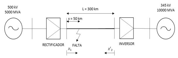
Figura 2.5 Esquema del sistema para una falta en x=100~km y resistencia de falta  $R_f=1~\Omega$
