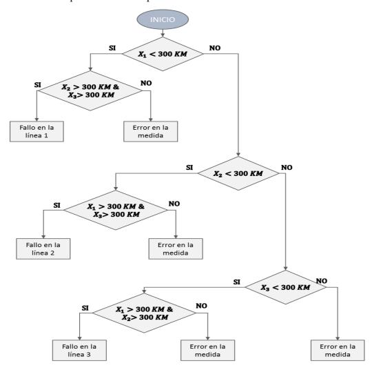
Figura 3.2 Algoritmo de estimación de línea afectada por fallo eléctrico.
