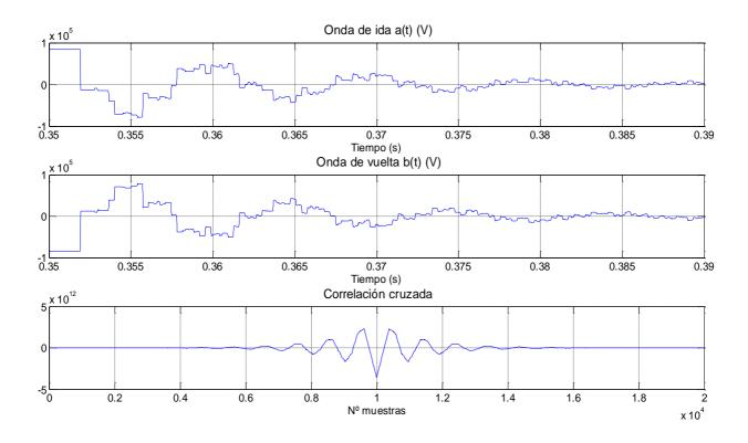
Figura 3.10 Ondas medidas por el inversor 2: a) Onda de vuelta desde la falta hasta el rectificador  $a_2(t)$ . b) Onda de ida desde la falta hasta el inversor 2  $b_2(t)$ . c) Correlación cruzada entre  $a_2(t)$  y  $b_2(t)$ .
