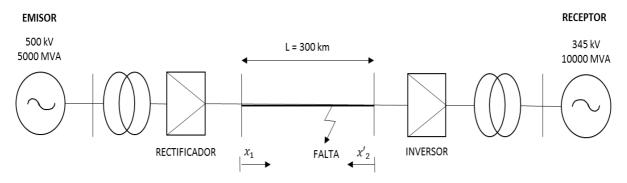
Figura 2.1 Esquema de localización de falta en un sistema HVDC
