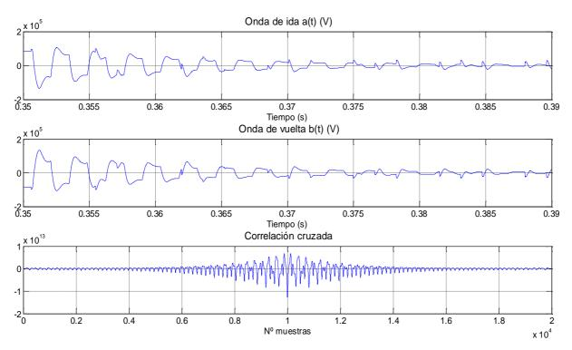
Figura 3.4 Ondas medidas por el rectificador: a) Onda de vuelta desde la falta hasta el rectificador  $a_1(t)$ . b) Onda de ida desde la falta hasta el inversor  $b_1(t)$ . c) Correlación cruzada entre  $a_1(t)$  y  $b_1(t)$ .
