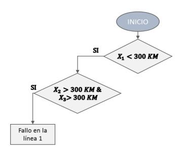
Figura 3.7 Diagrama de flujo para fallo en línea 1
