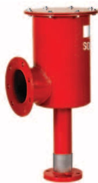
que facilita el control o el acceso al sello de vapores. El sello de vapores está hecho con vidrio y diseñado para cumplir con el intervalo de presión de ruptura que exige UL de 1 - 2 bar (10 - 25 psi). La superficie del deflector puede ser entera o partida, y está fabricada con acero que se puede empernar o soldar a un lateral del depósito.
