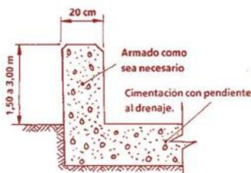
Ilustración 30 Esquema del muro exterior del cubeto
