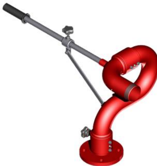
Ilustración 14 Esquema 3D de monitor espuma
