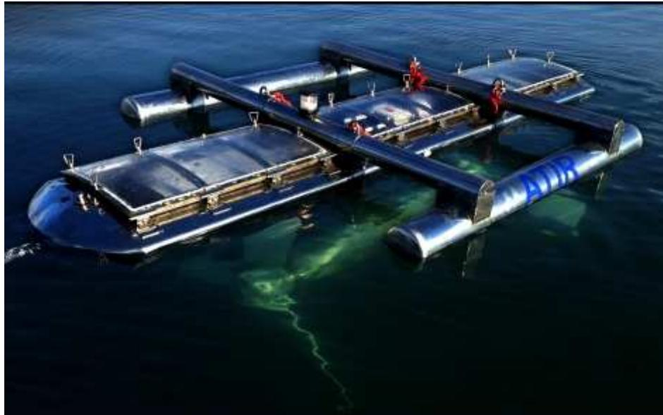
Ilustración 61: Plataforma flotante de la empresa Magallanes Renovables.
