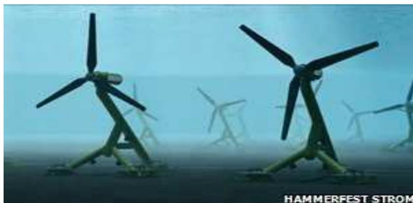
Ilustración 39: Tidal Stream Turbine.
