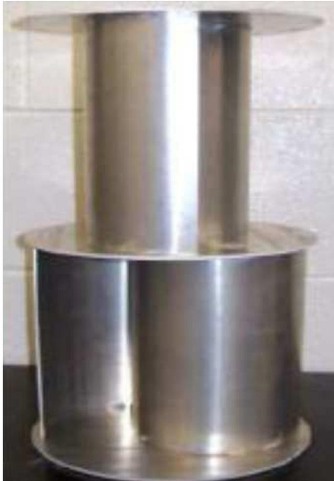
Ilustración 30: Turbina Savonius de dos etapas.
