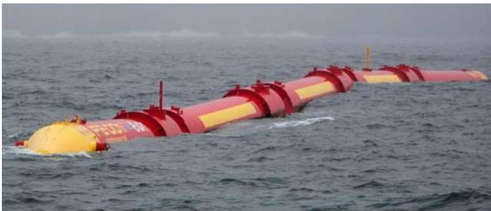
Ilustración 5: Dispositivo Pelamis para el aprovechamiento de la energía de las olas.
