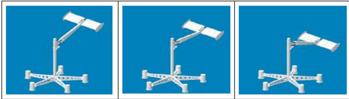
Ilustración 33: Ciclo completo del Generador Stingray (ver de izquierda a derecha).
