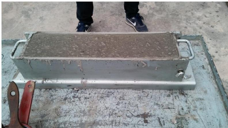
*Figura 9.11. Probeta lista para desencofrar.*
