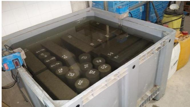
*Figura 9.15. Baño de curado donde se introducen las probetas.*
