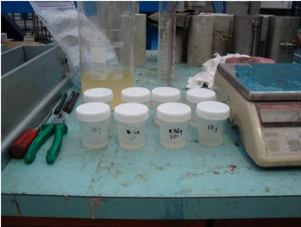
**Figura 8.14.** Preparación del superplastificante: pesada.
