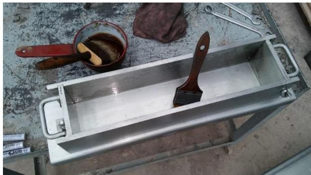
**Figura 9.1.** Molde para probeta prismática cubierta de desencoformante.
