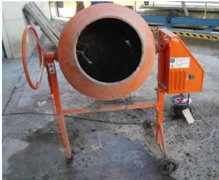
**Figura 9.5.** Aspecto de la primera hormigonera utilizada, hormigonera común. Las muestras que en ella se han realizado son: Dosificación 1, 2, 3 y 4.
