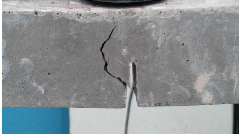
**Figura 12.3.** *Fractura irregular debido a áridos de mayor resistencia en la zona de entalla lo que obliga un crecimiento de grieta irregular o grieta iniciada en el enfriamiento de la propia probeta.*
