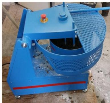
**Figura 9.6.** Aspecto de la segunda hormigonera utilizada. Hormigonera de eje vertical con capacidad máxima de 12 L. Las muestras que en ella se han realizado son: Dosificación 5, 6 y 7.
