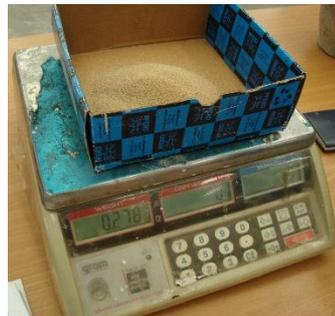
**Figura 8.7.** Pesado del material retenido en cada tamiz.
