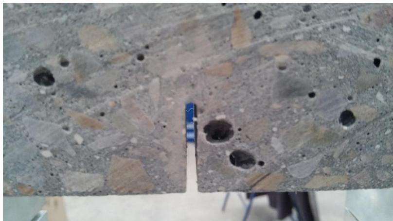
**Figura 12.4.** *Fractura irregular debido a defectos cercanos a la zona entallada, porosidad en este caso.*
