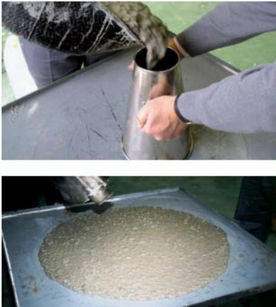
*Figura 5.2. Ensayo de escurrimiento (ensayo de extensión de flujo).*
