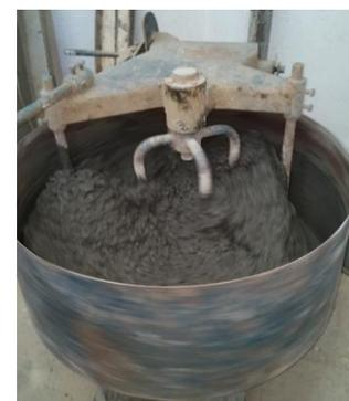
**Figura 9.7.** Aspecto de la tercera y definitiva hormigonera utilizada. Hormigonera de eje vertical con capacidad máxima de 50 L. Las muestras que en ella se han realizado son: Dosificación 8 y 9., además de toda la fabricación del hormigón con el que se realiza las probetas de ensayo.
