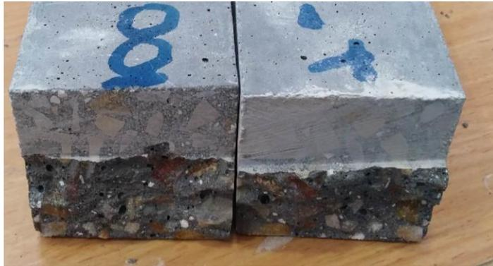
*Figura 12.2. Rotura transgranular propia de los H.A.R.*
