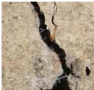
*Figura 5.6. Efecto cosido de las fibras en la matriz de hormigón (fibras de polipropileno en este caso).*
