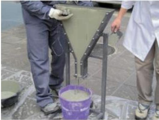
*Figura 5.4. Ensayo de escurrimiento con embudo en V.*
