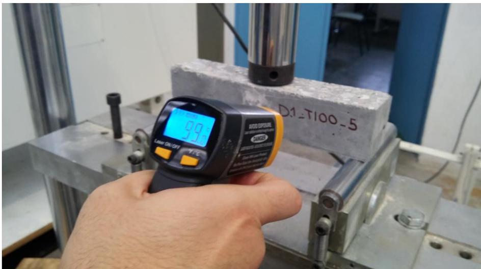
*Figura 10.9. Medida de temperatura en el ensayo de flexión en 3 puntos para la probeta D1\_T100\_5.*
