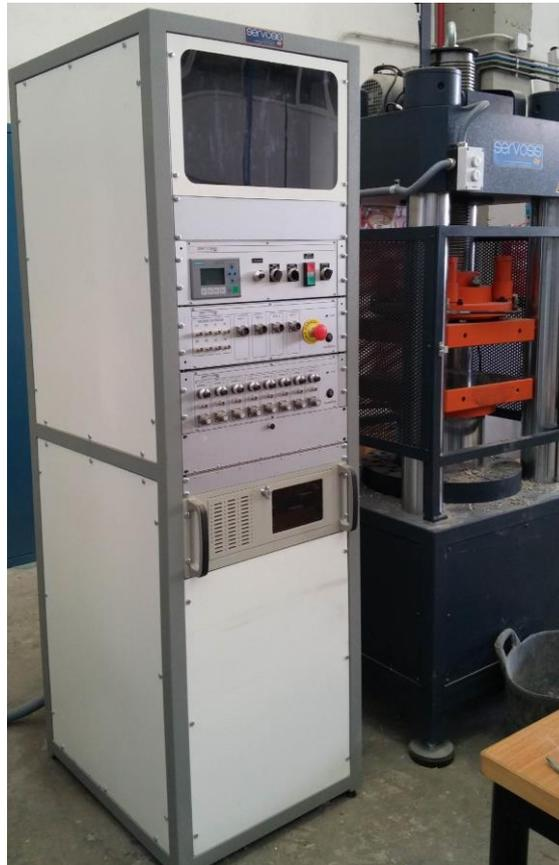
*Figura 10.10. Panel de control Servosis y Prensa hidráulica Servosis modelo MES 300*
