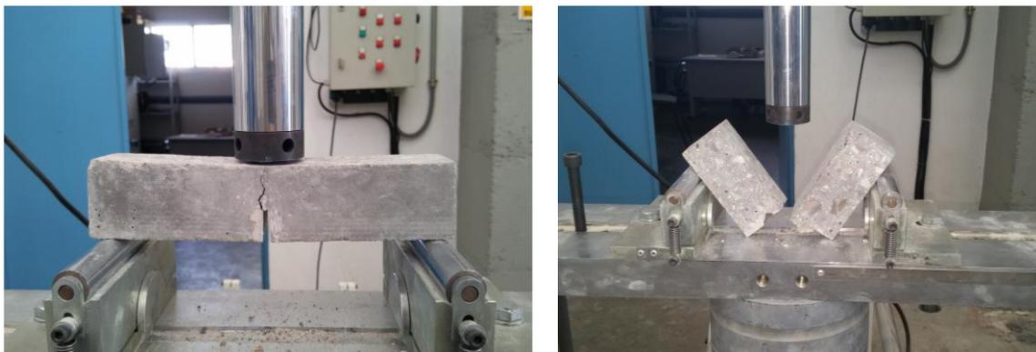
Figura 10.17. Ensayo de flexión en tres puntos. Carga hasta rotura.
