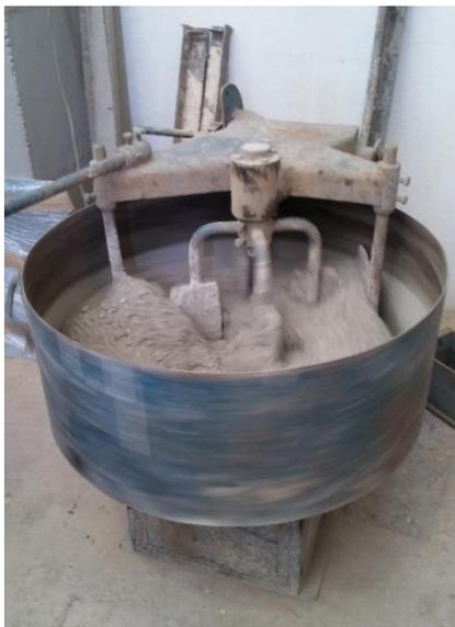
*Figura 9.8. Hormigonera de eje vertical mezclando el cemento con los áridos.*
