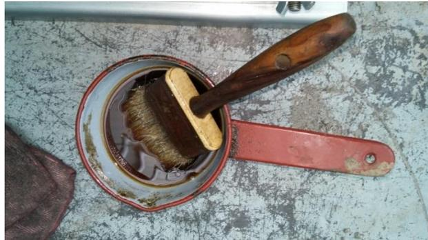
*Figura 9.2. Detalle del recipiente que contiene el líquido desencofrante utilizado.*
