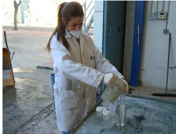
**Figura 8.15** Adición del superplastificante con la última parte de agua añadida.
