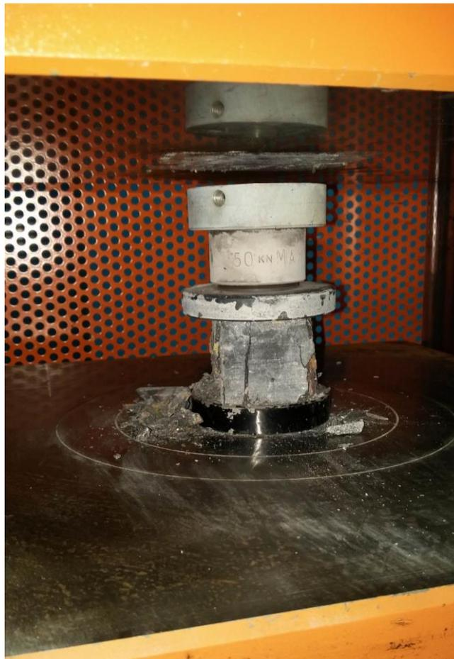
*Figura 10.11. Elemento que solventa los defectos que aparecen en las caras de las probetas cúbicas en el ensayo de compresión.*
