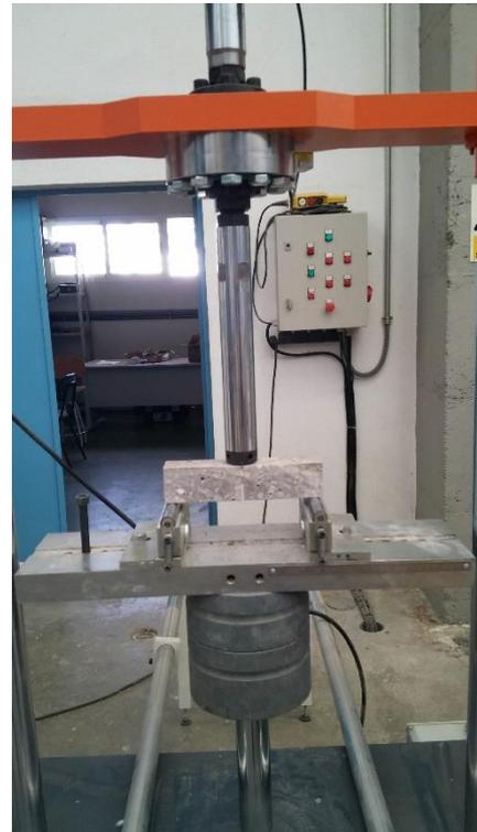
*Figura 10.13. Máquina servo hidráulica modelo ME 406/15 marca Servosis Ensayos 50*
