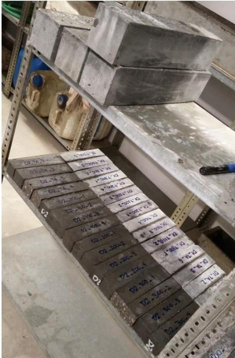
*Figura 10.5. Probetas prismáticas originales y probetas cortadas.*
