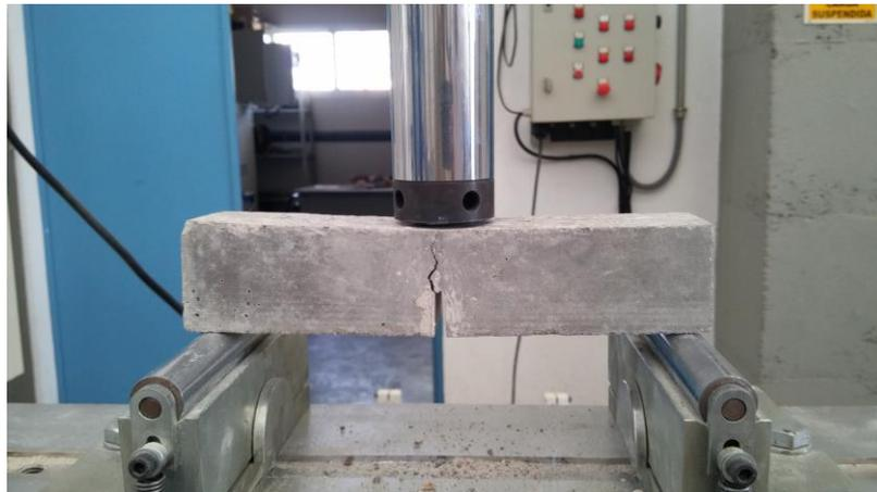
*Figura 12.1. Ensayo de flexión en tres puntos donde aparece el crecimiento de grieta.*
