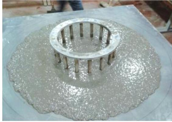
*Figura 5.5. Ensayo de escurrimiento con anillo japonés.*
