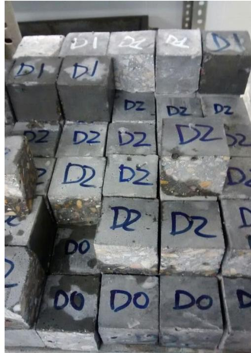
*Figura 10.6. Probetas cúbicas cortadas.*
