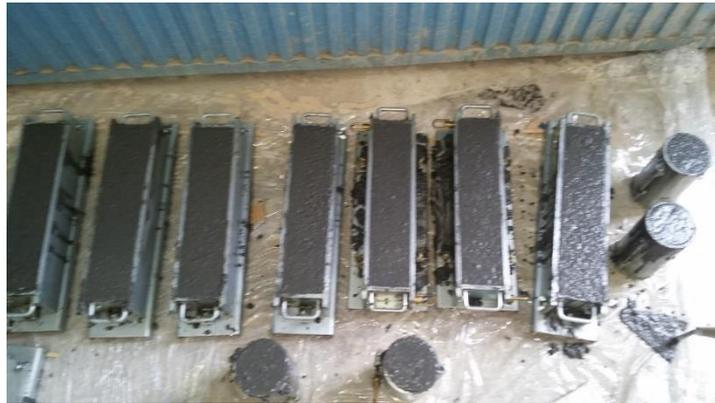
*Figura 9.10. Probetas de hormigón ya enrasadas listas para desmoldar a las 24 horas.*
