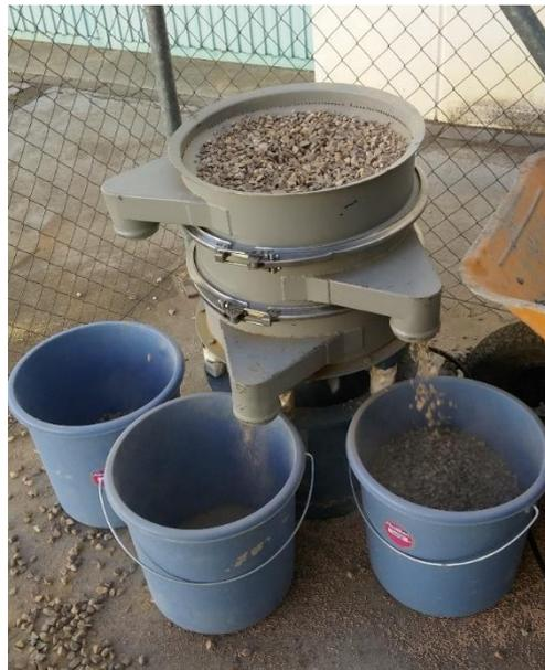
*Figura 8.2. Máquina de tamizado.*
