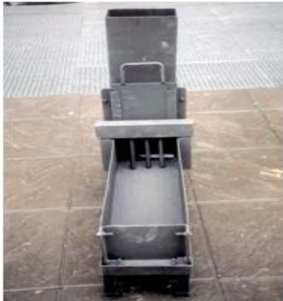
*Figura 5.3. Ensayo de la caja en L.*
