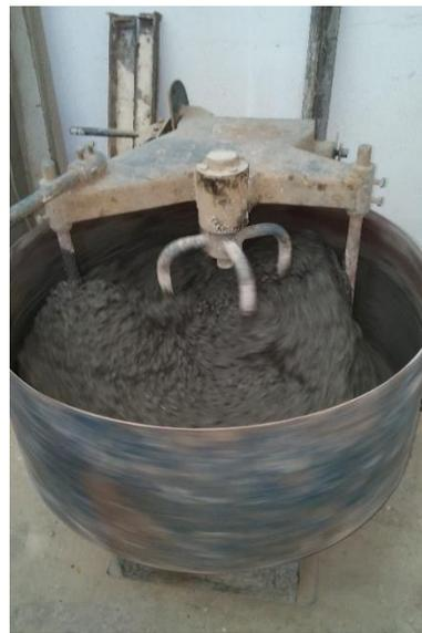
*Figura 9.9. Hormigonera de eje vertical mezclando la masa con el agua y plastificante añadido.*
