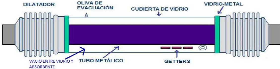
Fig. 4.2: Esquema de los componentes de un tubo absorbente
