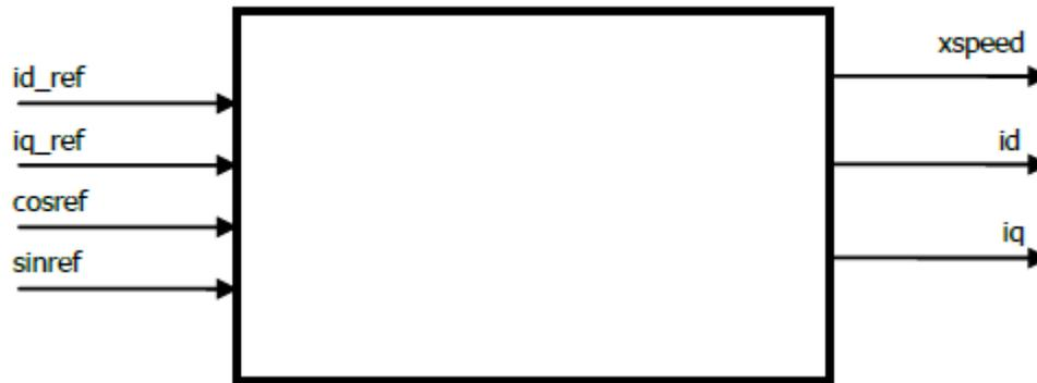
Figura 2.16: Definición de las entradas/salidas del generador estático
