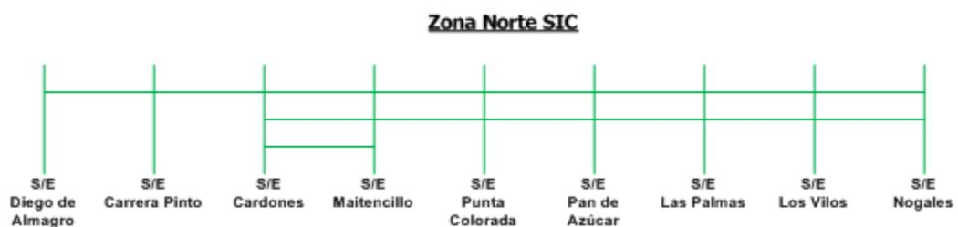
Figura 1.2: Unifilar simplificado del SIC Norte
