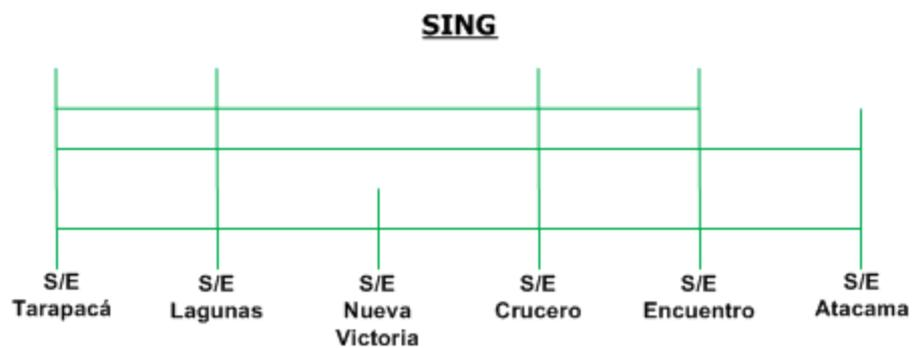
Figura 1.1: Unifilar simplificado SING
