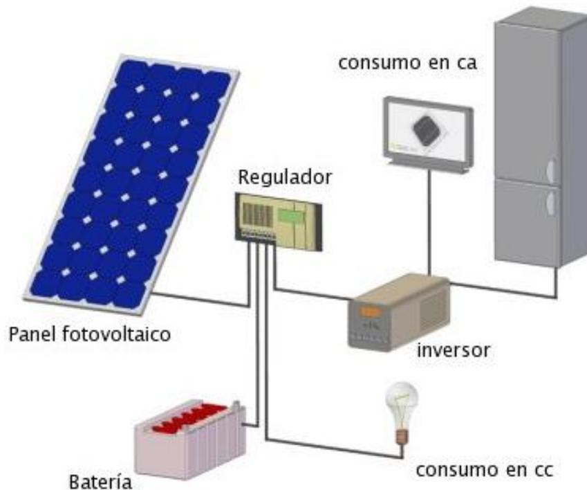
**Ilustración 3.1.** Esquema básico de una instalación FV para una vivienda aislada.
