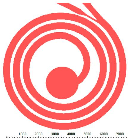
Figura A.2.: Máscara de un separador espiral ( $\mu m$ )
