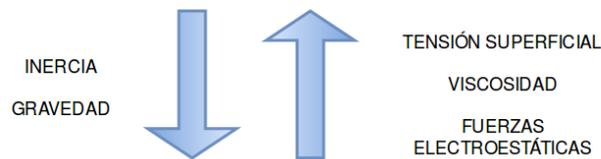
**Figura 3.4.:** Variación de las fuerzas en escala microscópica respecto a la macroscópica
