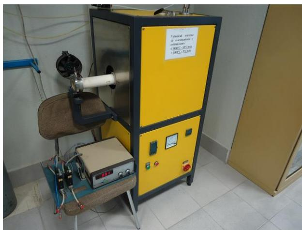
FIGURA 4.5.1 HORNO TUBULAR AGNI MODELO IGM RTH-180-50-1H
