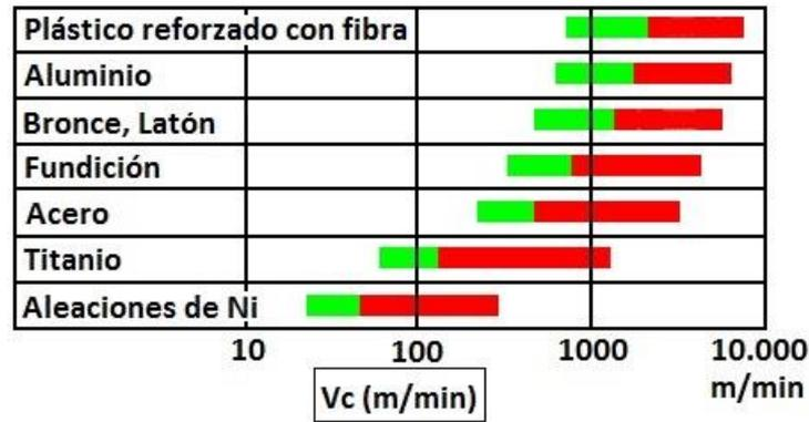
FIGURA 1.3 RANGOS DE VELOCIDADES DE CORTE EN MECANIZADO CONVENCIONAL Y EN MAV
