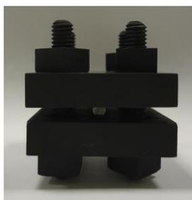
FIGURA 4.5.2 LANZADERA DE GRAFITO USADA PARA INTRODUCIR LAS MUESTRAS EN EL HORNO
