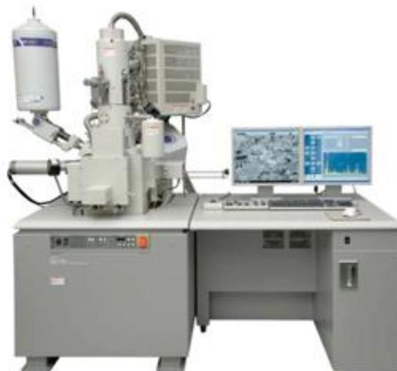
FIGURA 4.6.4 SEM HITACHI S-4800 SEM-FIELD EMISSION GUN.
