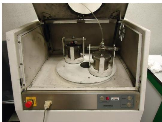
FIGURA 4.3.2 MOLINO PLANETARIO PULVERISETTE
