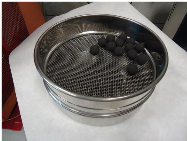
FIGURA 4.3.5 TAMIZ USADO PARA SEPARAR LAS BOLAS DE ACERO DEL MATERIAL
