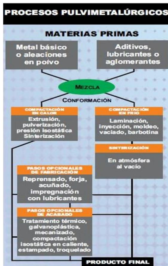
FIGURA A.2.1 ESQUEMA DE LOS PROCESOS PULVIMETALÚRGICOS
