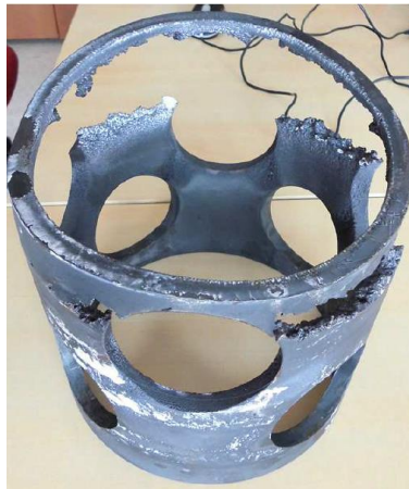
Figura 66. Interno dañado por operación en sales. Fuente: Flowserve.
