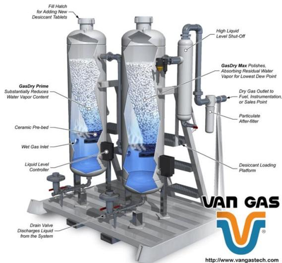
Ilustración 3-8 Purificación simple por agente desecante (fuente: Van Gas Tech)
