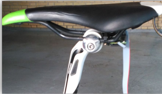
Figura 5.6 Montaje en Tija de fibra de carbono
