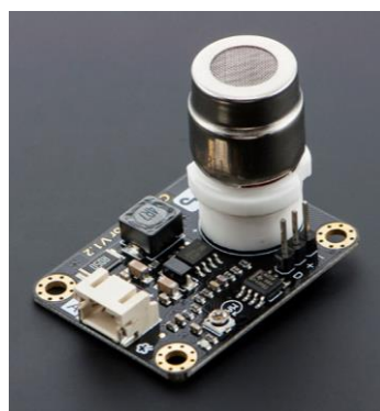
Figura 27: Vista general del sensor de CO 2
