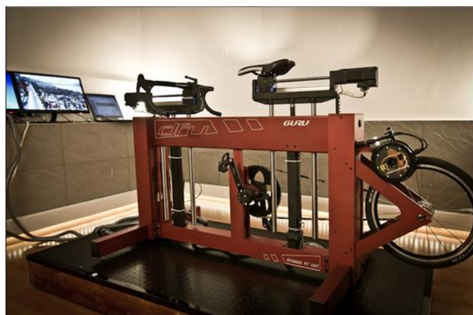
FIGURA 1. BICICLETA CONFIGURABLE PARA ESTUDIOS BIOMECÁNICOS.
