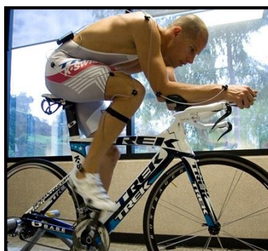
FIGURA 4. CICLISTA CON SENSORES LEDs.
