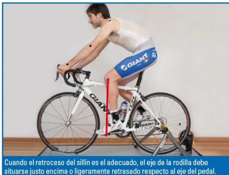
FIGURA 27. REFERENCIA PARA CALCULAR EL RETROCESO DEL SILLÍN [10].
