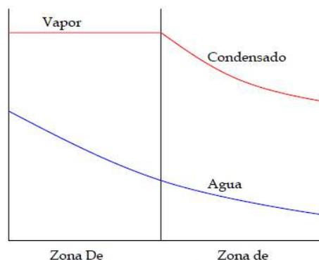
Figura 7. Temperatura fluidos en condensador
