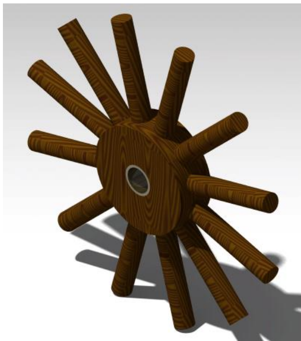
Figura 33: anillo, cojinete y radios de la rueda
