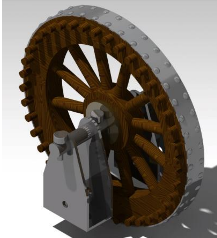
Figura 37: rueda, eje y soportes de la rueda
