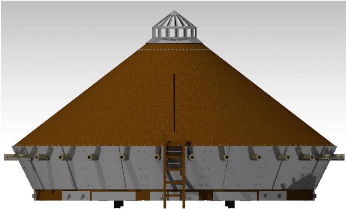
Figura 59: vista del carro de combate donde se puede apreciar la posición de la escalera respecto a la puerta
