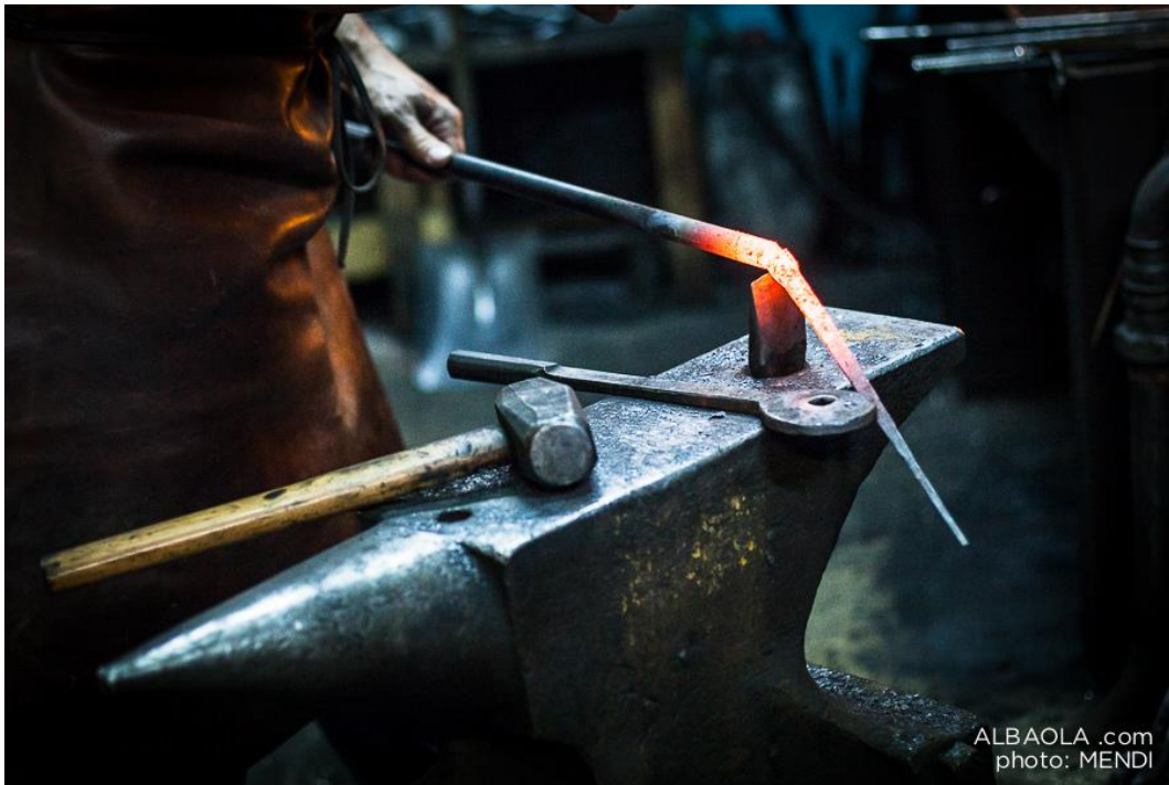
Figura 21: herrero forjando clavo de hierro para la nao San Juan
