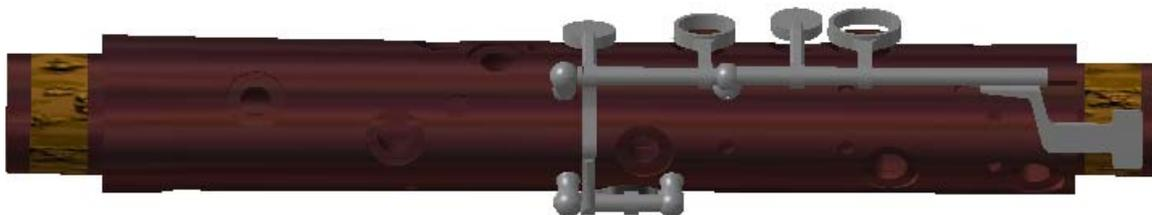
*Figura 69: Ensamblaje de las anillas del cuerpo superior*
