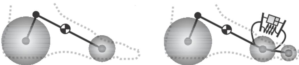
FIGURA 1.5: Los dos modelos de pie probados por Millard *et al.*, el primero tiene el pie como un sólido rígido y el segundo divide en pie en dos partes rígidas.
