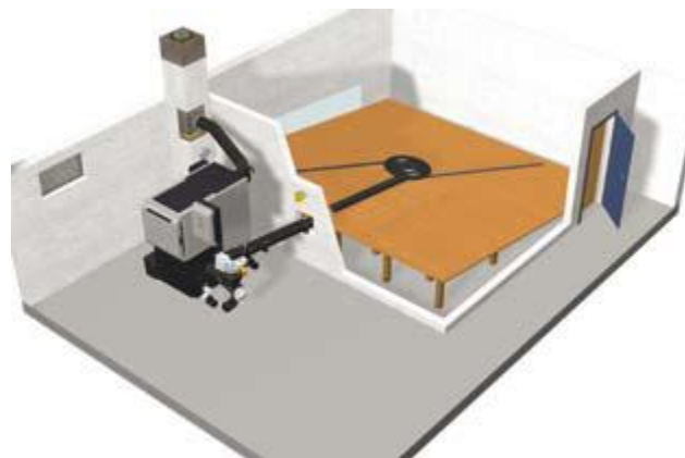
Figura 44: Silo de almacenamiento de obra civil con un lado inclinado
