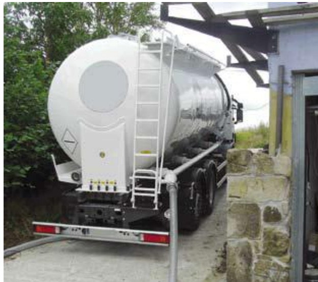
Figura 50: Sistema de suministro mediante camión cisterna neumático
