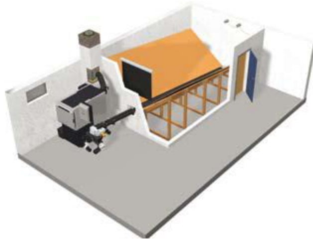
Figura 43: Silo de almacenamiento de obra civil con dos lados inclinados
