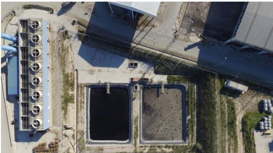
Figura 2-5: Vista aérea de la planta de eliminación de lixiviados y balsas asociadas. Fuente: Ecocentral Granada
