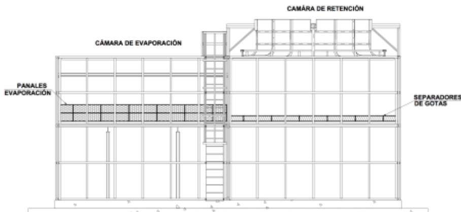
Figura 3-2: Alzado de una celda de evaporación. Fuente: INCRO
