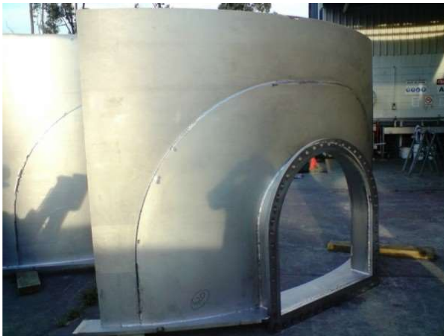
Figura 6-1. Puerta de limpieza rasante montada sobre plancha de la virola.
