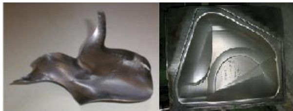
Figura 1-1. Implante maxilofacial fabricado por SPIF en Titanio (izquierda) y ejemplo de conformado superplástico utilizado en la industria aeroespacial (derecha).
