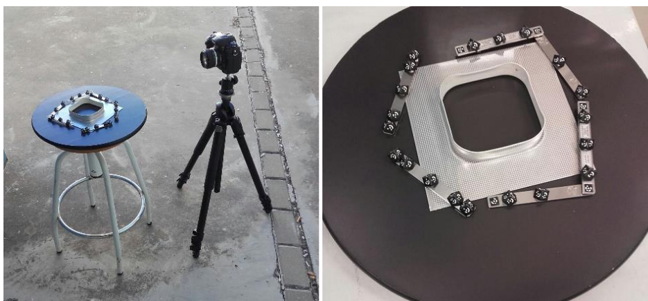
Figura 3-49. Sistema de captura de imágenes y probeta con patrón de círculos grabados y marcadores de posición de ARGUS.
