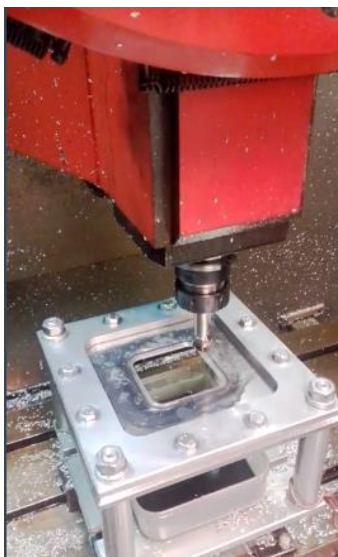
Figura 3-41. Movimiento de la herramienta según las trayectorias generadas.
