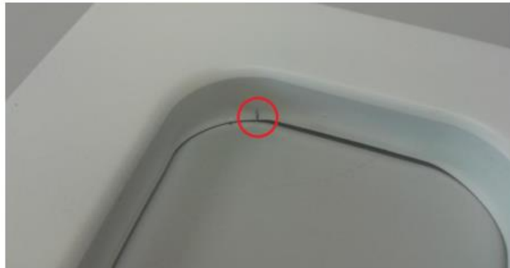
Figura 3-43. Fractura de la probeta de 16 mm en la zona cercana a la zona C.
