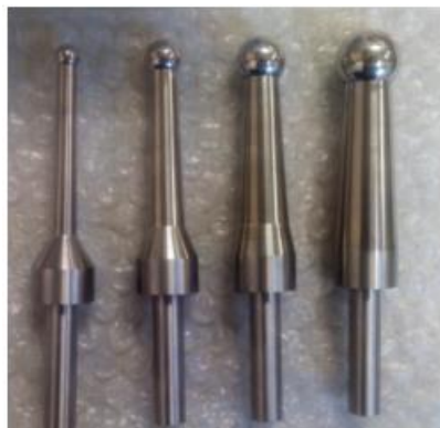
Figura 3-37. Diseño de herramienta de conformado. De izquierda a derecha: \phi 12 , \phi 16 y \phi 20 .
