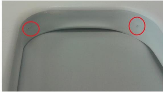
Figura 3-42. Fractura de la probeta a mitad de pared en la zona C.
