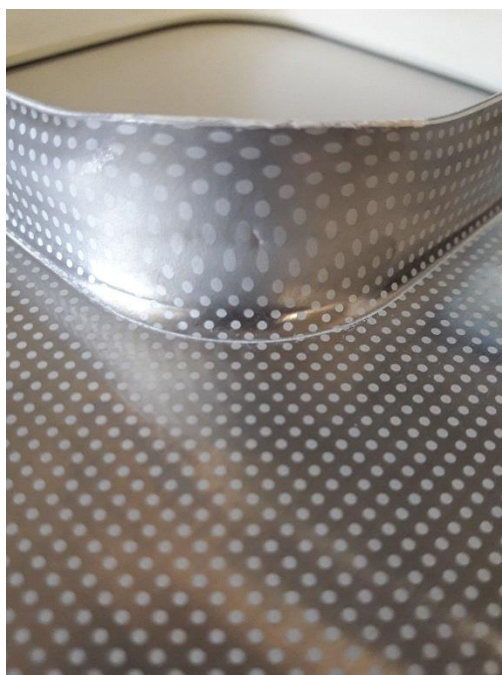
Figura 3-58. Puntos donde se aprecia la rotura en chapa deformada por punzón de diámetro 12mm, zona A.
