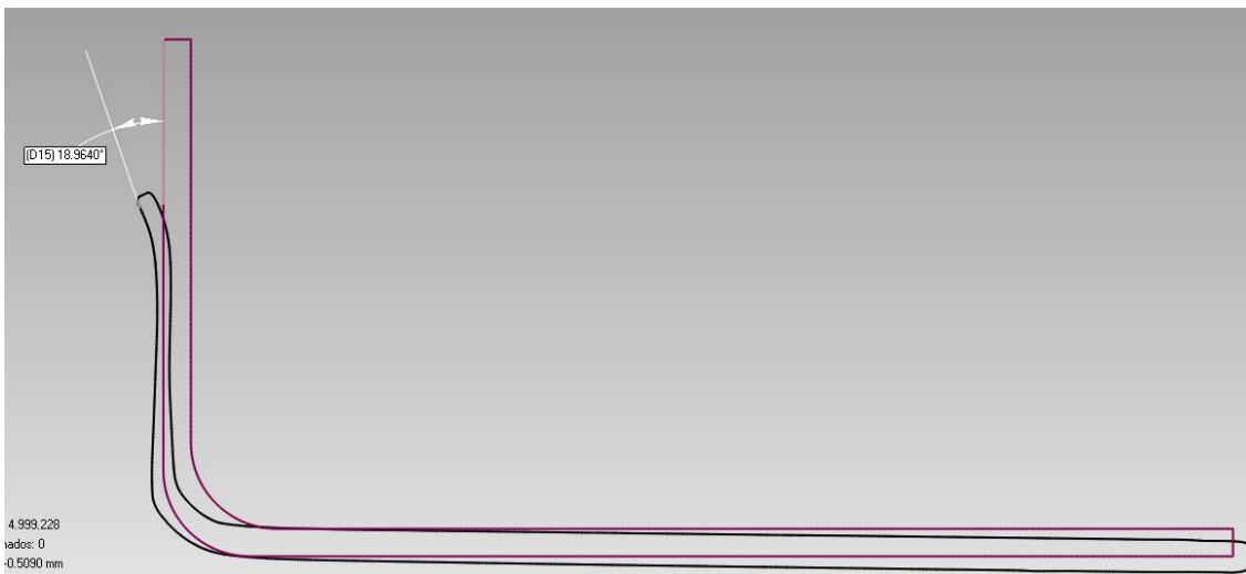
Figura 3-90. Ángulo de separación en sección creada por plano 45° (esquina chapa), punzón 16 mm.
