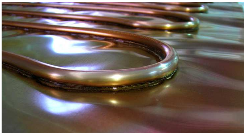
Figura 1.13 Detalle de la parte posterior de un absorbedor tipo serpentín
