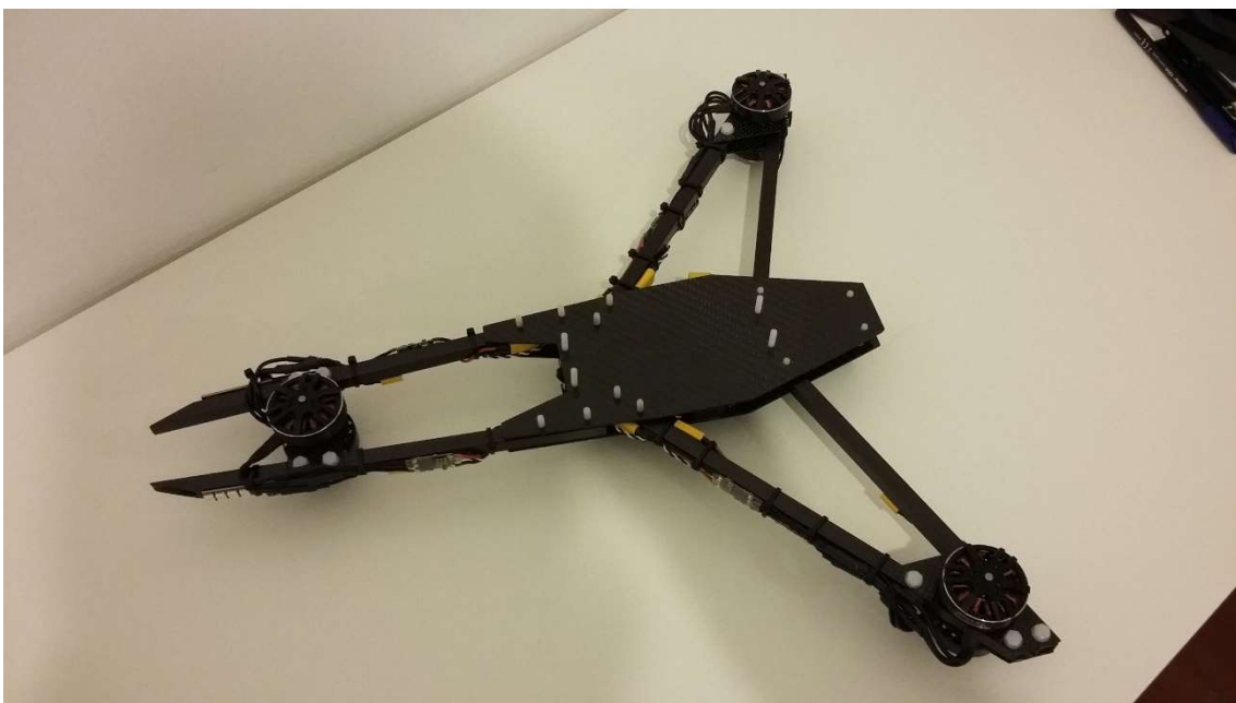
Figura 3.8.8: Chasis con motorización montada.
