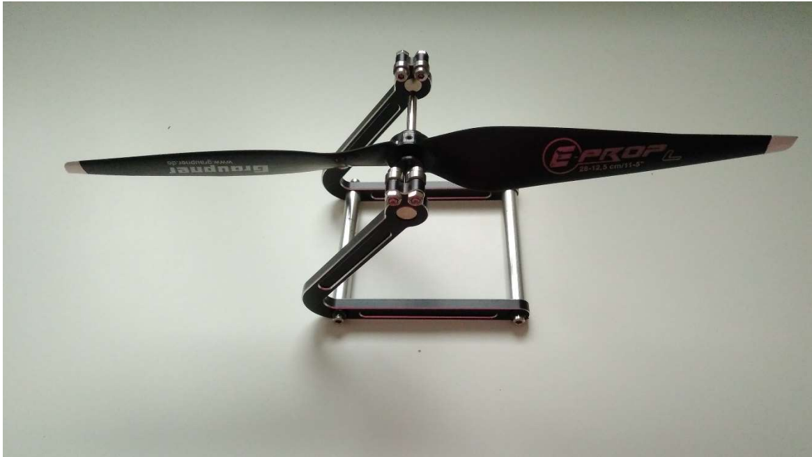
Figura 3.6.2.9: Hélice perfectamente equilibrada en balanza magnética.
