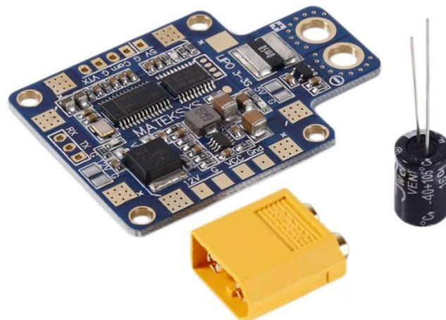
Figura 3.6.5.8: Placa de distribución de potencia con sistema OSD integrado.
