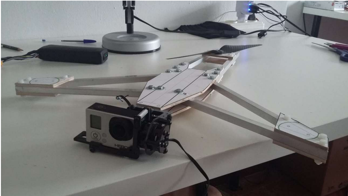
Figura 3.8.2: Pruebas de colocación de gimbal en maqueta de chasis.
