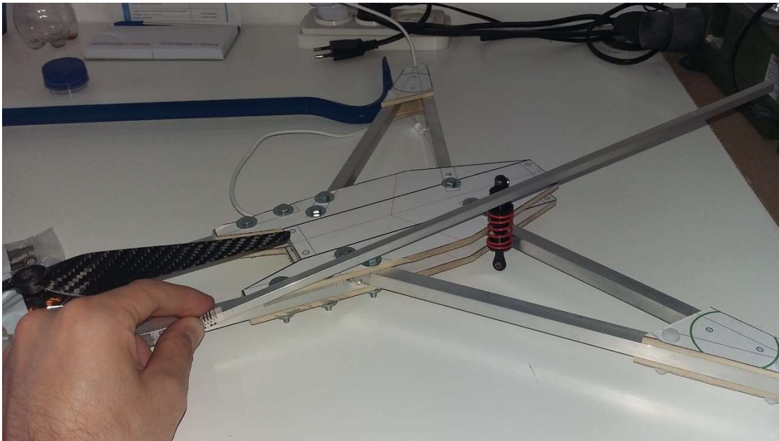
Figura 3.8.3: Pruebas del tren de aterrizaje sobre la maqueta del chasis.
