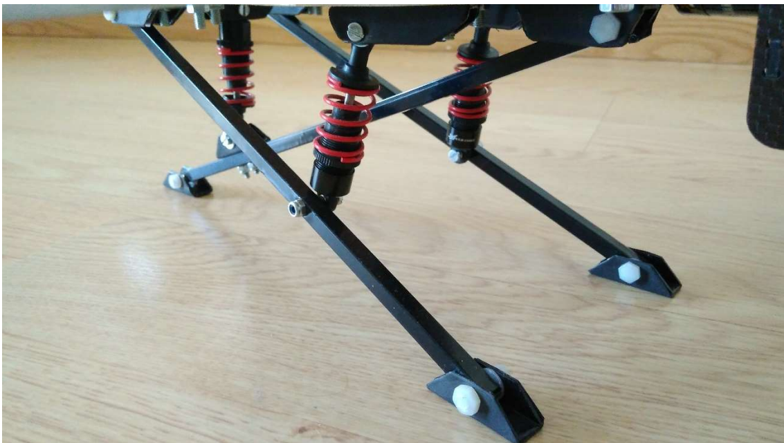
Figura 3.7.1: Tren de aterrizaje amortiguado de 3 puntos de apoyo.
