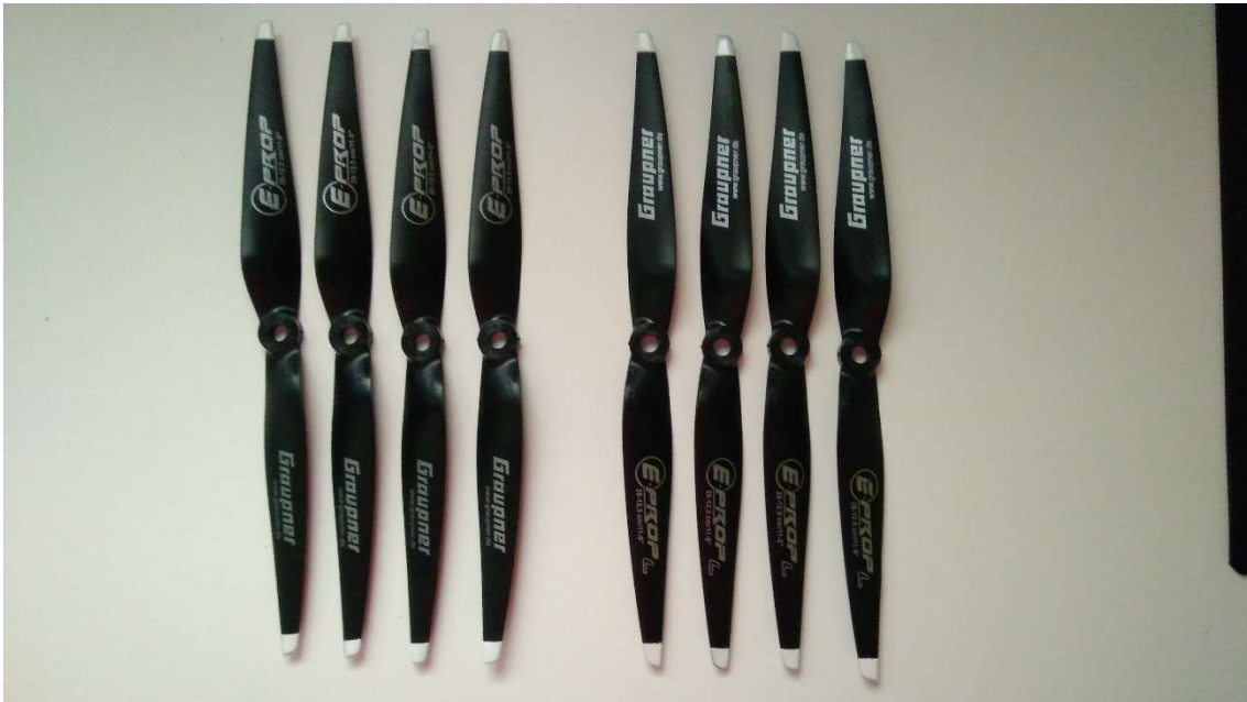
Figura 3.6.2.8: Conjunto de hélices graupner de 11" de diámetro y un paso de 5".
