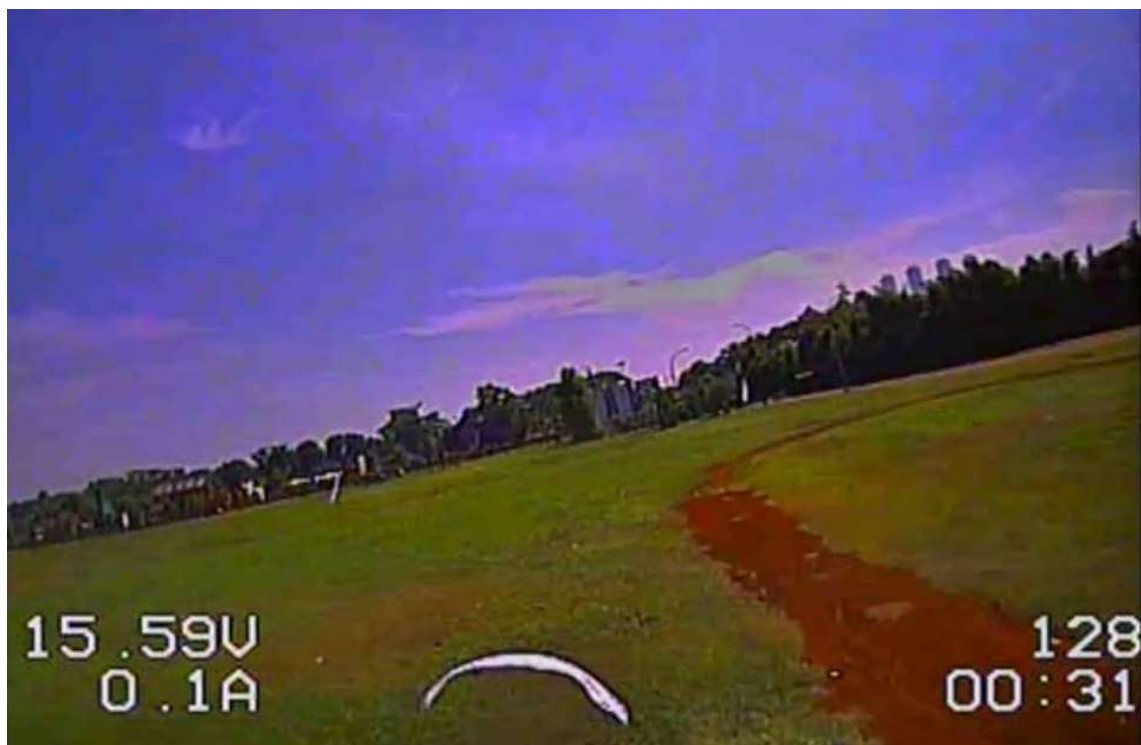
Figura 3.6.5.7: Sistema simple de OSD con información de batería.
