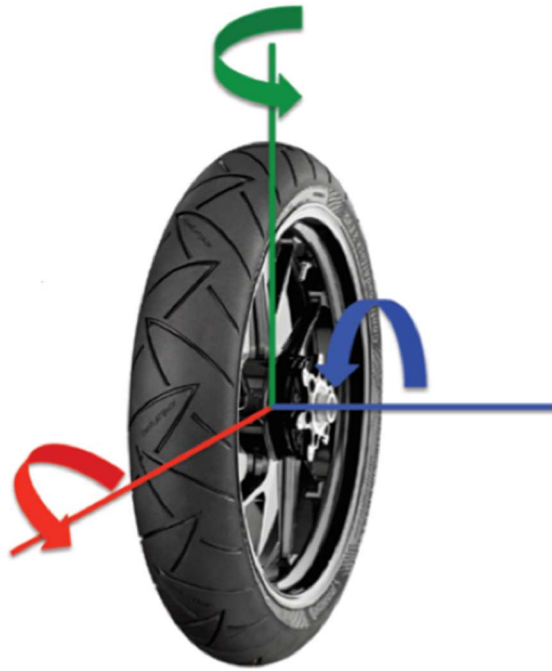
Figura 3.4.5: Diagrama de momentos en rueda.
