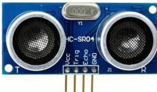
Figura 2-5. Disposición pines del sensor HC-SR04
