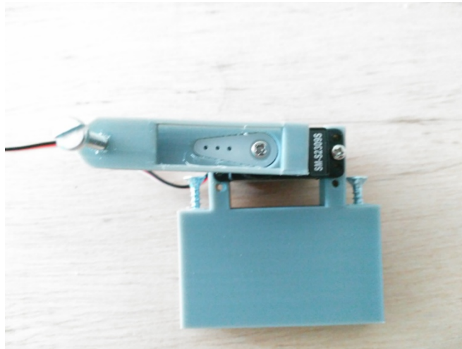
Figura 2-14. Colocación del servomotor en pieza impresa
