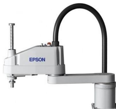
Fig. 1-18: SCARA horizontal de la marca japonesa EPSON
