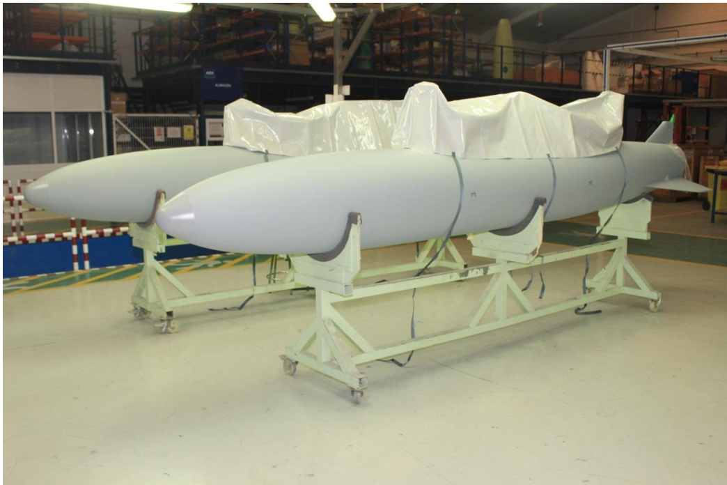
Figura 9: depósitos de combustible 1000L
