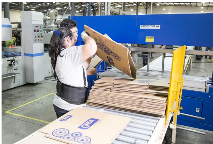
Figura 1.4 Conformado manual de cajas
