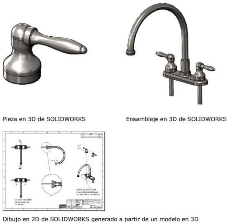
Figura 3.1 Ejemplos piezas SolidWorks
