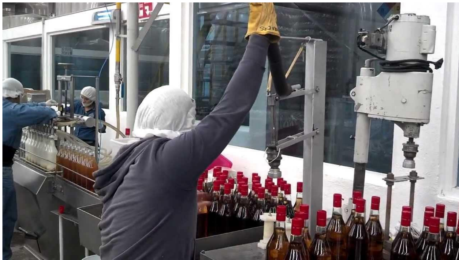
Figura 1.3 Colocación de tapones
