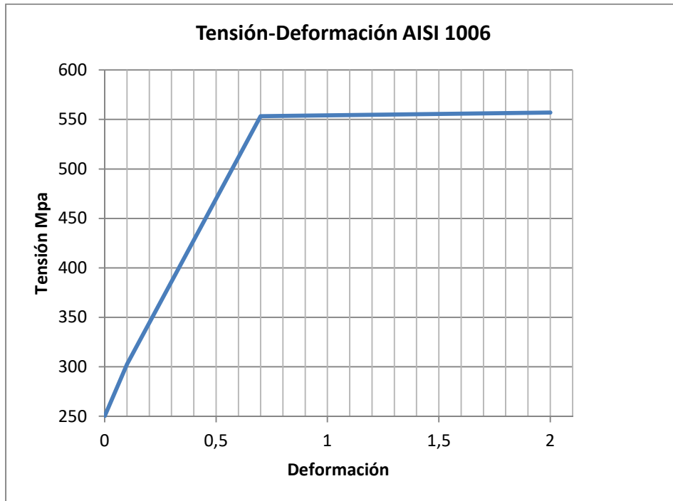
Gráfica 1. Curva tensión-deformación del acero AISI 1006 según los datos del programa Deform3D.
