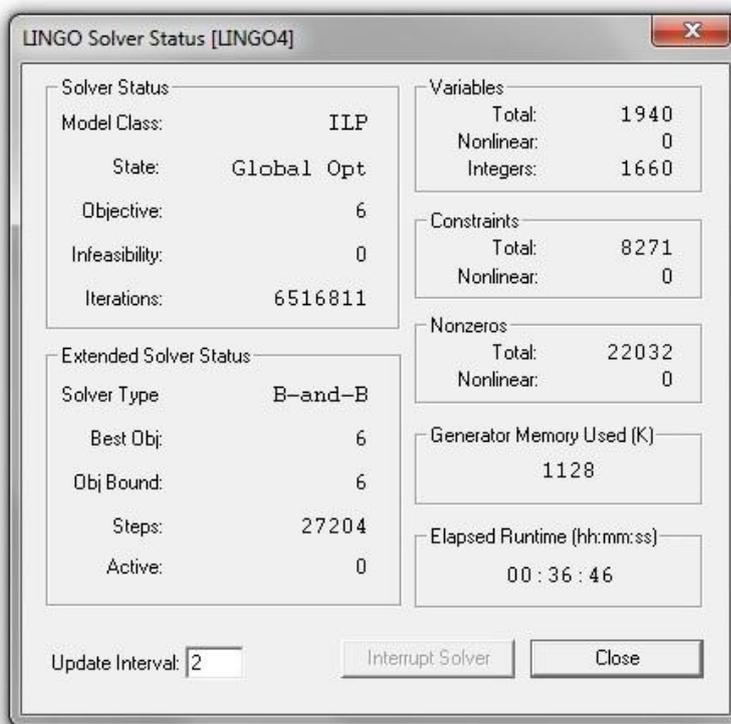
En casi 37 minutos, después de 6516811 iteraciones, Lingo consigue una solución óptima de **6 pilotos** necesarios para dicha programación de 7 días, 70 vuelos y 3 aviones.
