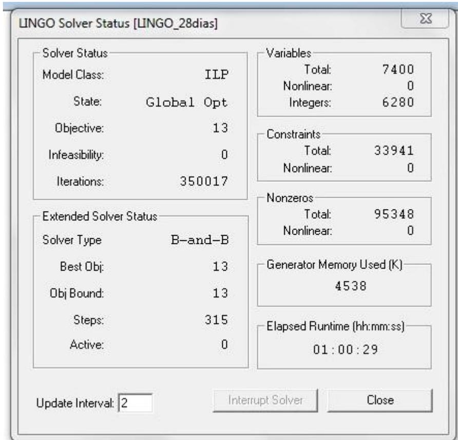
El valor óptimo en este caso de la función objetivo fué de **13 pilotos** necesarios y suficientes para realizar todos los vuelos, cumpliendo todas las restricciones.
