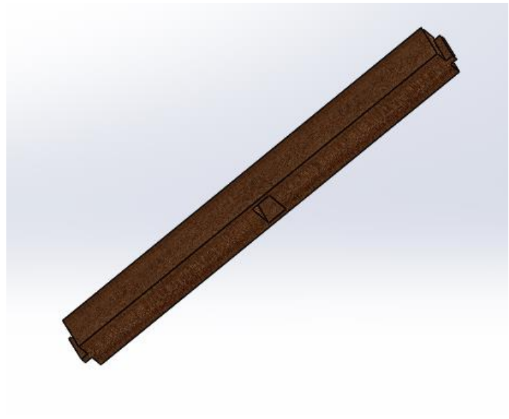
Figura 3-10. Madero superior, enlaza mástil con maderos exteriores, e.p.
