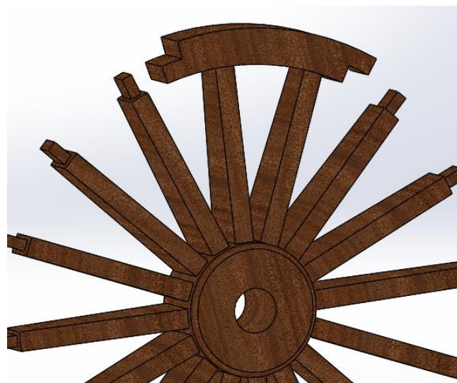
Figura 3-5. Ensamble radios - parte del aro, e.p.
