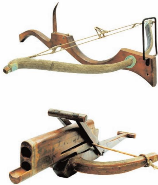
Figura 1-12. Ejemplos de ballestas con mecanismos que permiten facilitar la carga de estas, Grayson et al. (2007)
