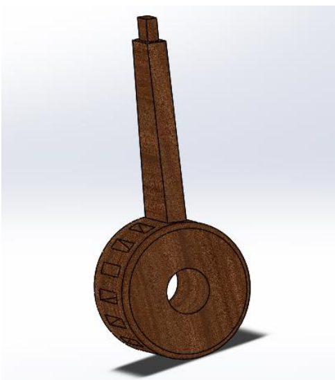
Figura 3-4. Ensamble calabaza - radio, e.p.
