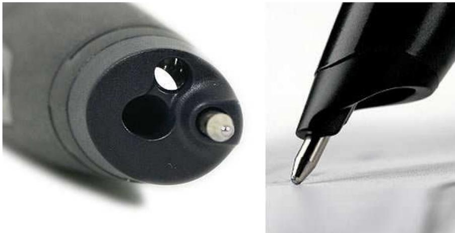
Al escribir el bolígrafo digital automáticamente captura microimágenes del patrón de puntos del papel (50 capturas por segundo). Cada captura contiene suficientes datos como para determinar la posición exacta del bolígrafo y todo lo que con él se
