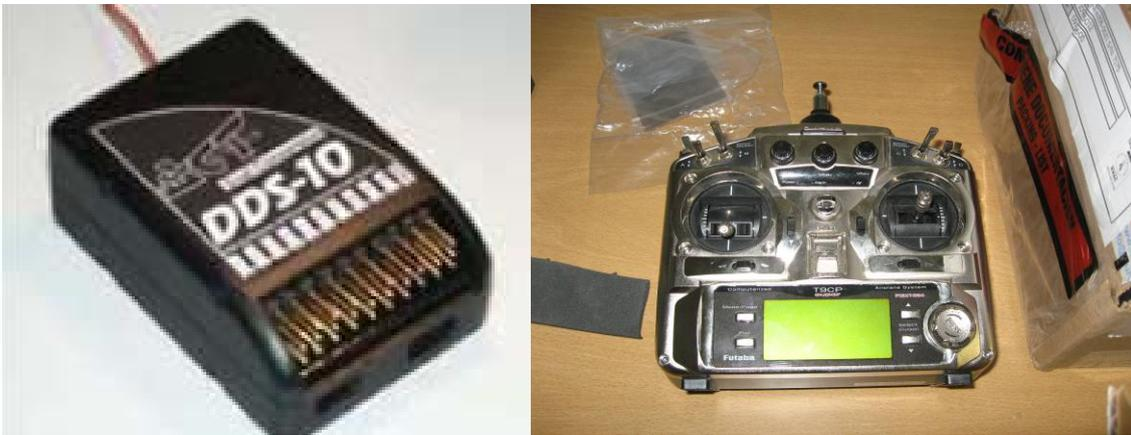
**Figura 2.14:** Receptor y emisor de radiofrecuencia utilizados.
