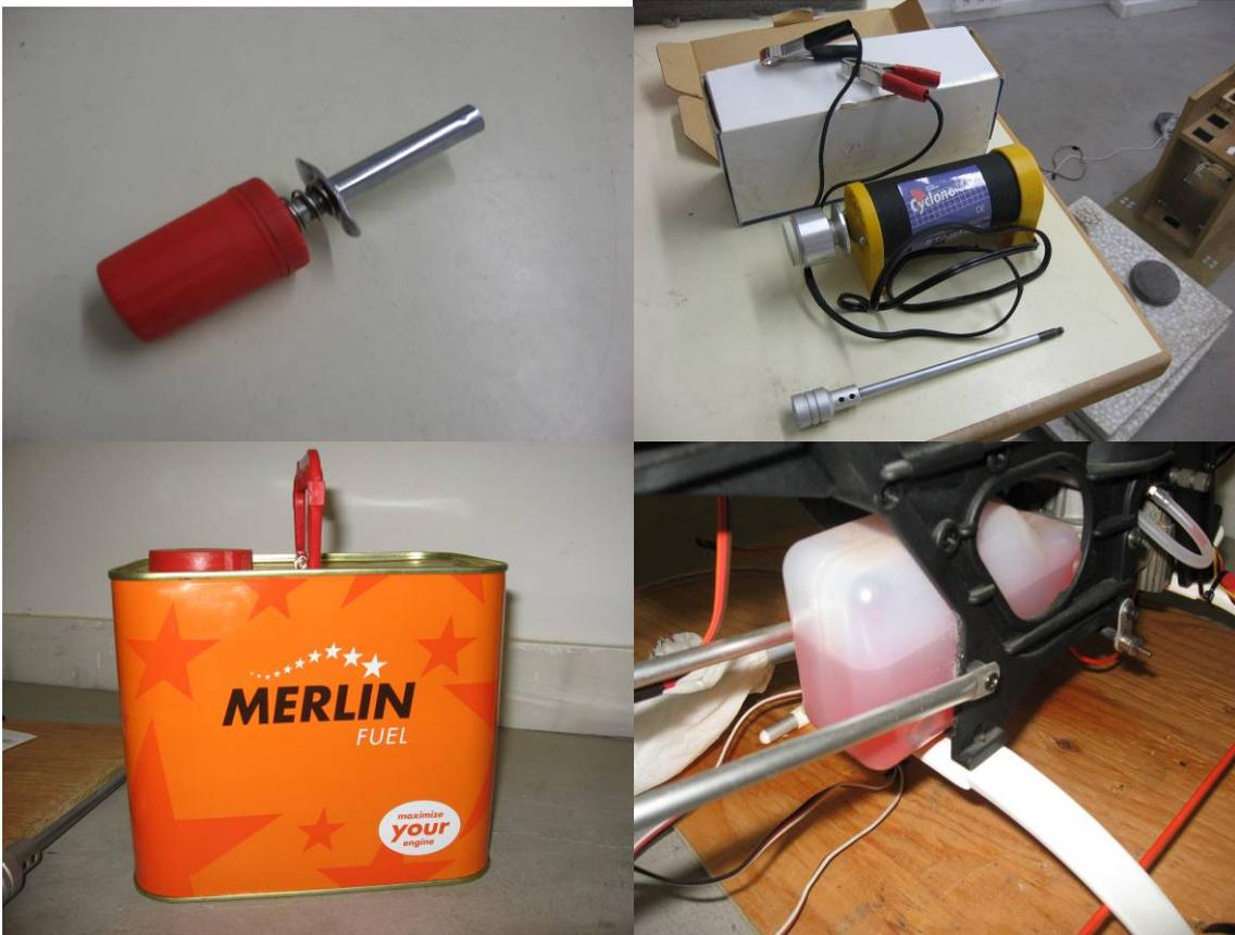
**Figura 2.7:** Chispa, motor de arranque, combustible utilizado y depósito de combustible del helicóptero.
