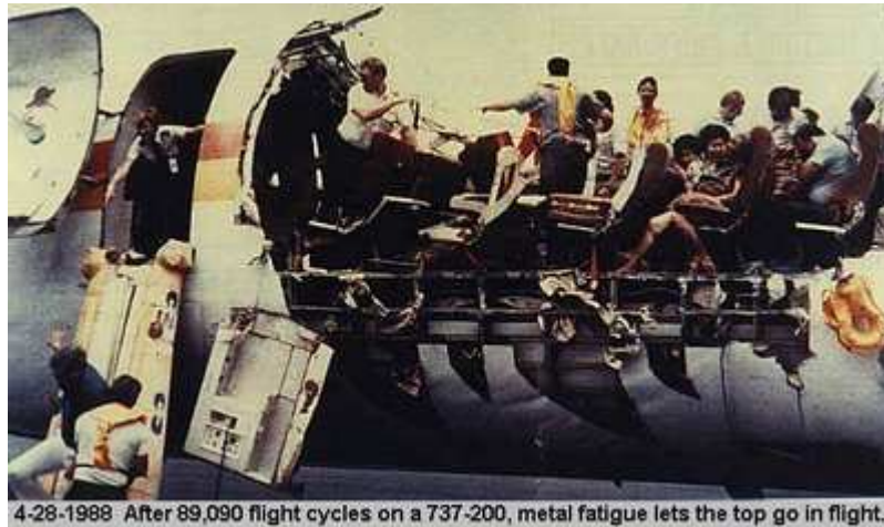
Figura 110: Estado del avión 737 de Aloha Airlines tras el aterrizaje
