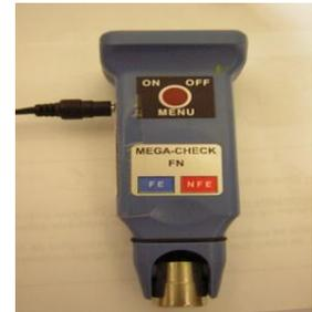
Para medir el espesor de pintura en los productos se mide el espesor en el mismo punto 2 veces, y se utiliza la media. Si los valores de las mediciones varían demasiado, se tomará una tercera medida.
