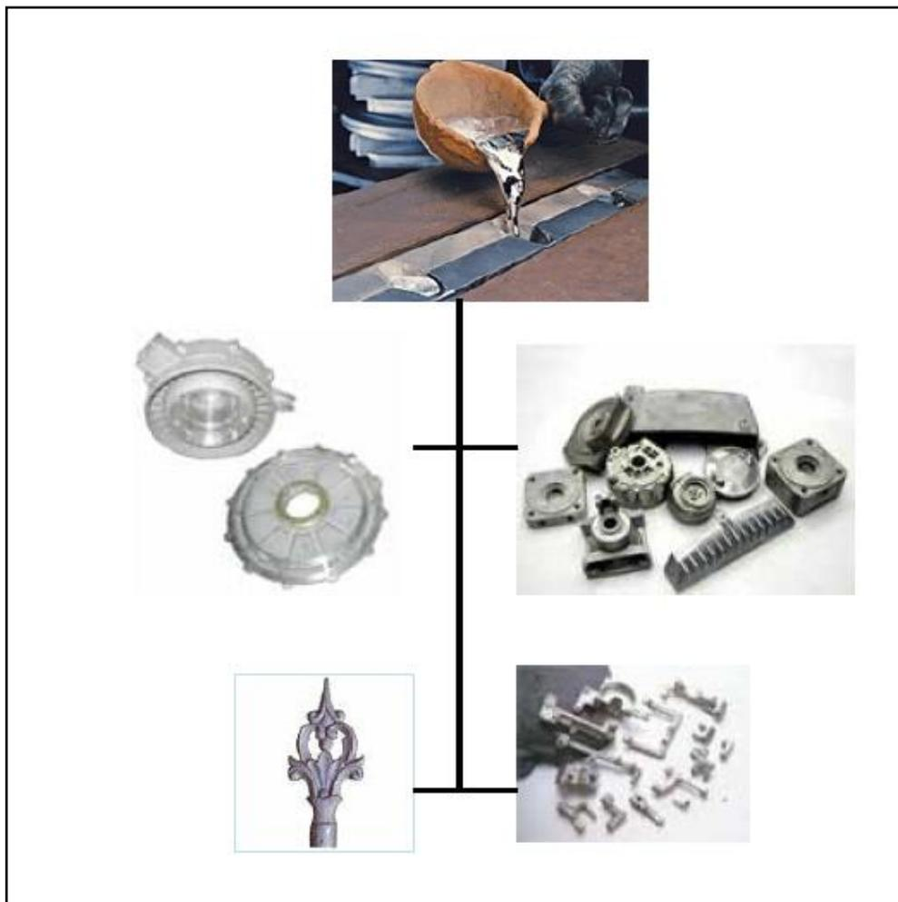
Figura 5. Piezas obtenidas mediante moldeo de aleaciones de Aluminio.
