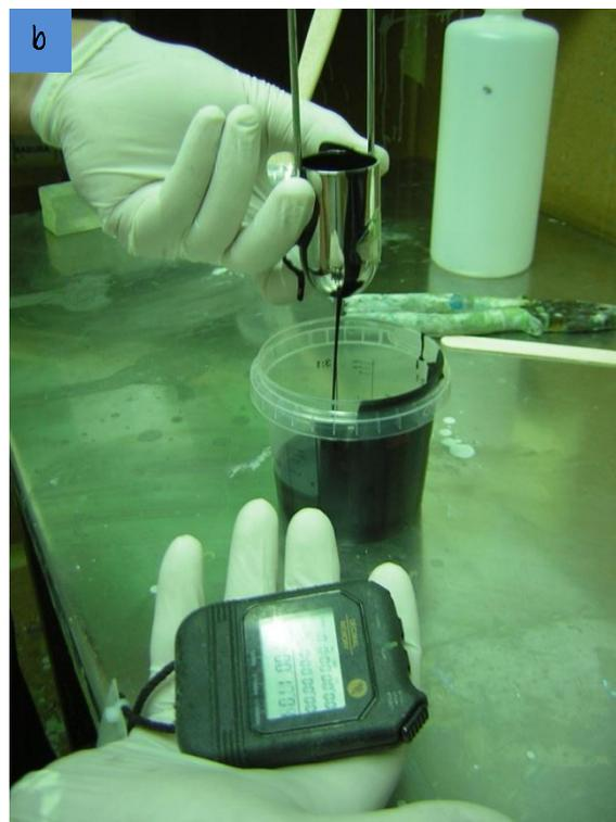
Figura 39. Medición de viscosidad. a) Copa Aforn<sup>o</sup>4 b) Copa Zahn.
