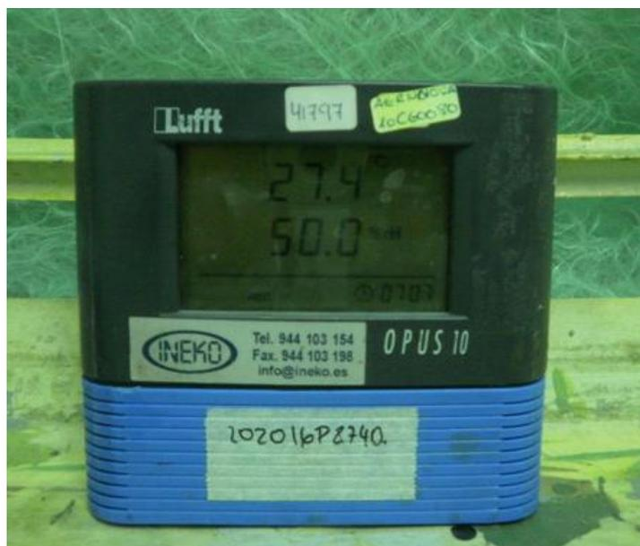
Figura 24. Termohigrómetro
