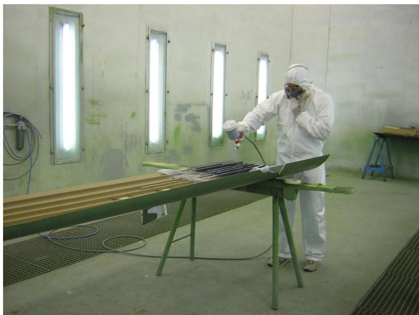
Figura 2. Cabina de pintura y pintor con EPI.
