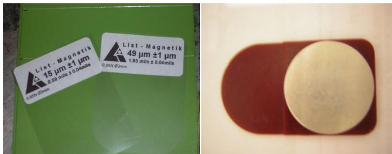
Figura 51. Plaquetas para calibración.
