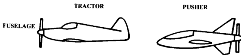
Figura 24: Esquema de configuración “puller” o “pusher”
