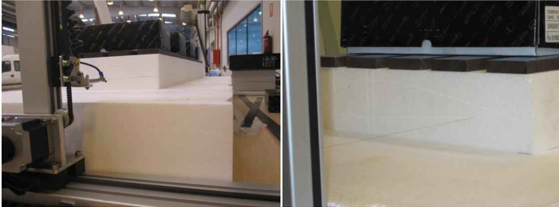
2. Previamente al pegado de las diferentes partes, es conveniente recortar en el interior de la espuma los huecos donde irán alojados los tubos que rigidizan las dos semialas, el refuerzo en el encastre al que van unidos los dos tubos, los cables de los servos y el propio servo con su varilla de mando. Una vez que se tiene el cuerpo principal del ala en espuma con los rigidizadores y refuerzos pegados en él con resina, se procede a su recubrimiento con fibra de carbono.
