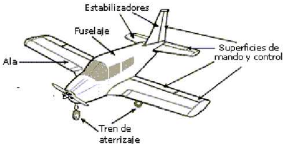
Figura 6. Composición de la estructura de un avión.
