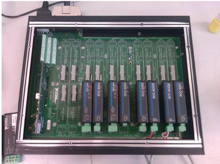
Figura 33: Hardware de adquisición de datos
