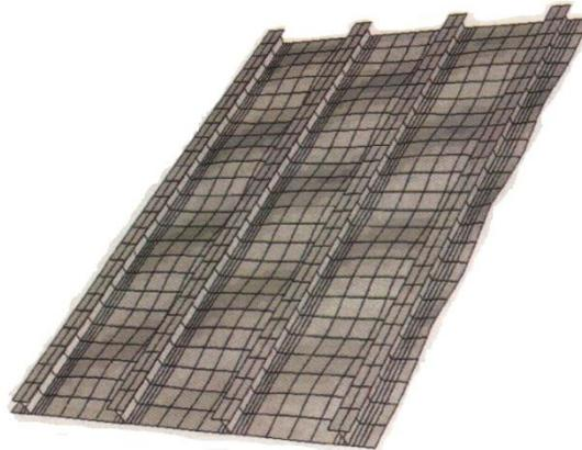
Fig.1.2. Deformada del panel tras la 1ª carga de pandeo (tomado de [8]).
