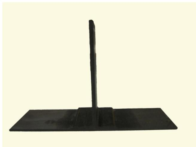
*Fig.2.37. Vista de la probeta tipo ALCAS obtenida.*
