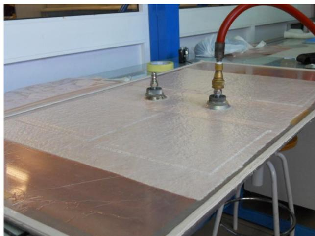
*Fig.2.13. Plancha de curado preparada para el autoclave.*
