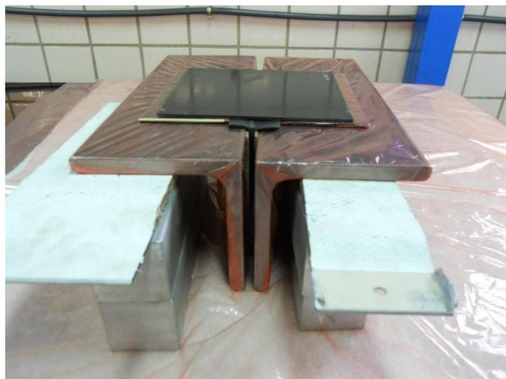
Fig.2.33. Disposición de todos los elementos de la configuración B antes de aplicar la bolsa de vacío.
