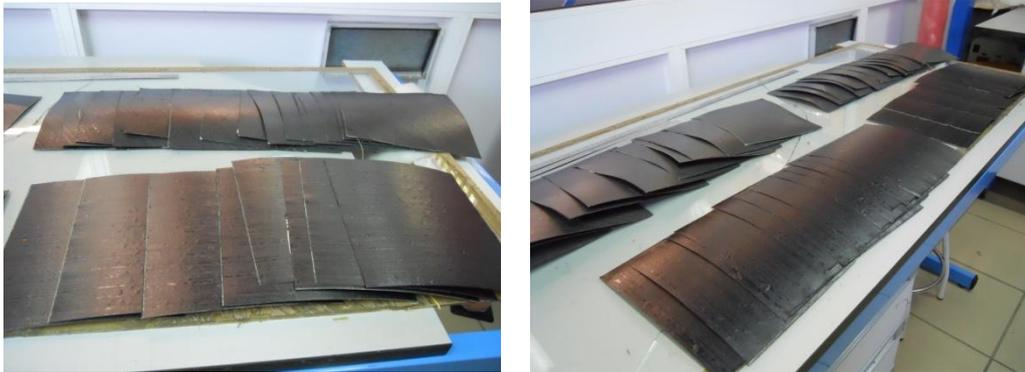
*Fig.2.6. y 2.7. Láminas de Prepreg cortadas.*
