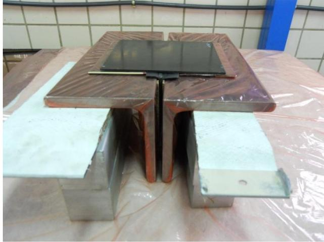
*Fig.2.23. Unión de los rigidizadores con el panel antes de aplicar la bolsa de vacío.*
