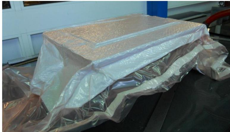
*Fig.2.36. Bolsa de vacío antes de entrar en autoclave.*
