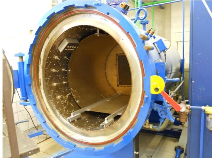
Fig.2.15. Autoclave utilizado para el proceso de curado.
