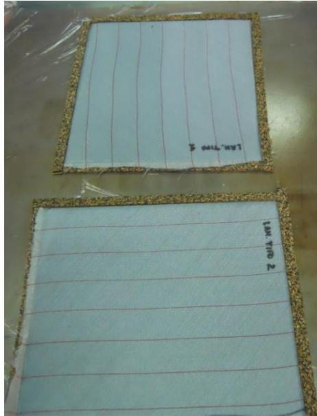
*Fig.2.12. Paneles rodeados de corcho en la plancha de curado.*
