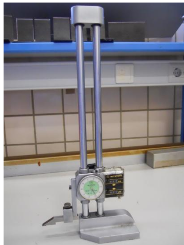
Fig.3.9.Gramil utilizado para marcar la posición de las bandas.
