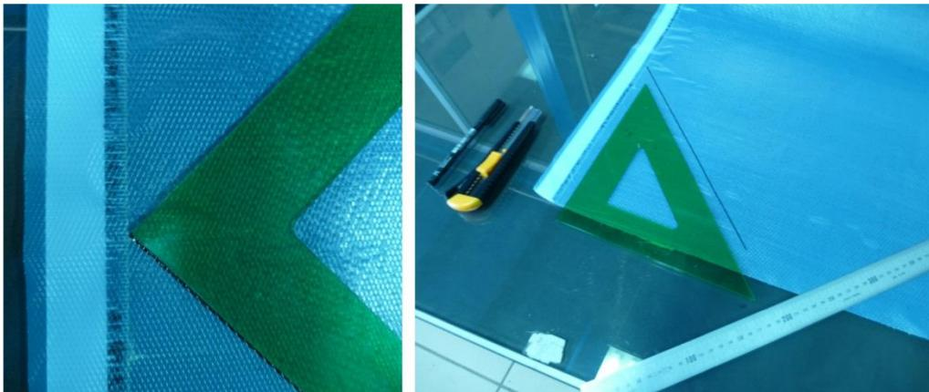
Figura 3.5: Trazado de las láminas y detalle del orillo del rollo de pre-preg.
