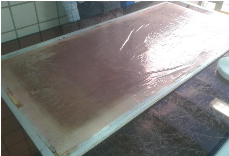
Figura 3.8: Preparación de la *bolsa de vacío*. Paso 1.
