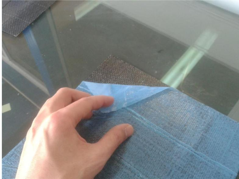
Figura 3.6: Proceso de apilado.
