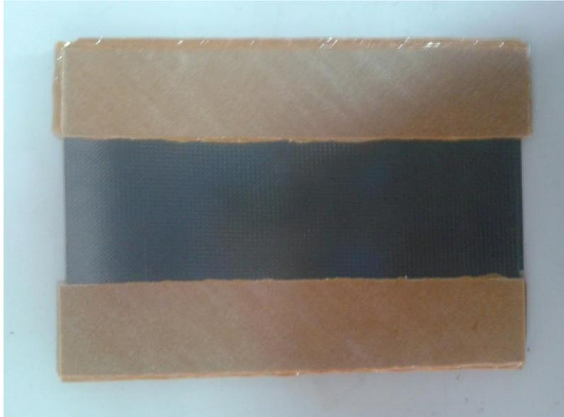
Figura 3.19: Resultado tras aplicación de los tacones de fibra de vidrio.
