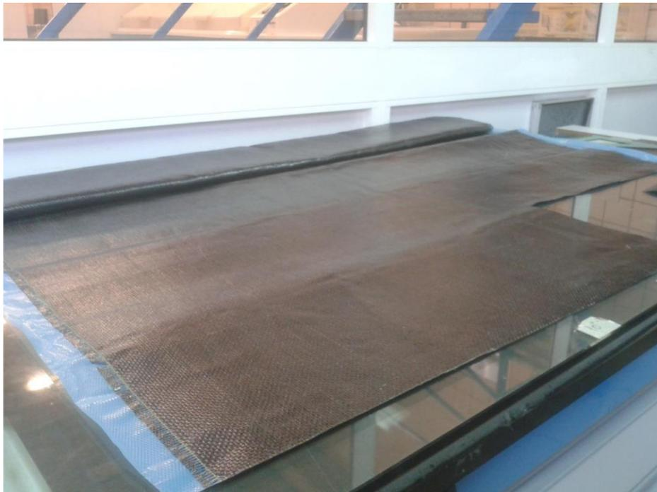
Figura 3.1: Rollo de tejido pre-preg empleado en la fabricación de las probetas
