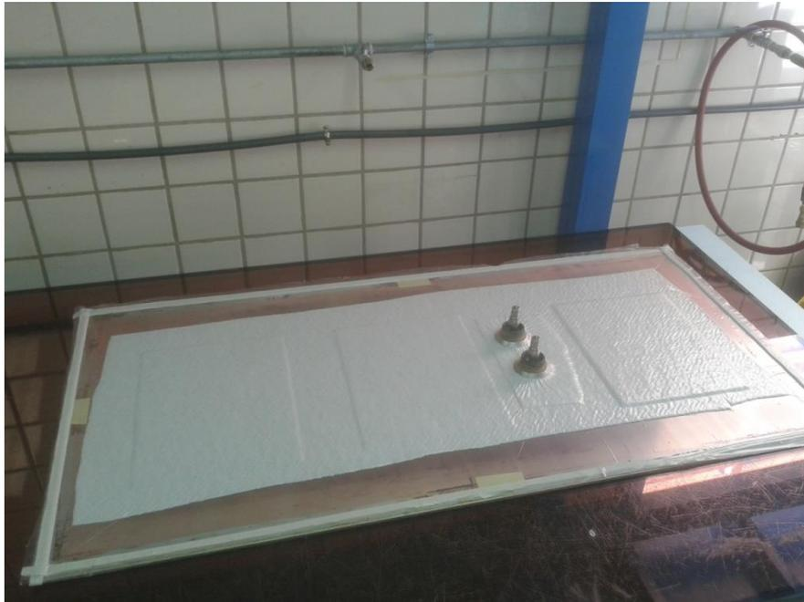
Figura 3.12: *Bolsa de vacío* finalizada.
