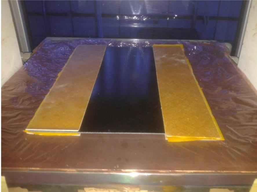
Figura 3.17: Colocación de los tacones de fibra de vidrio.
