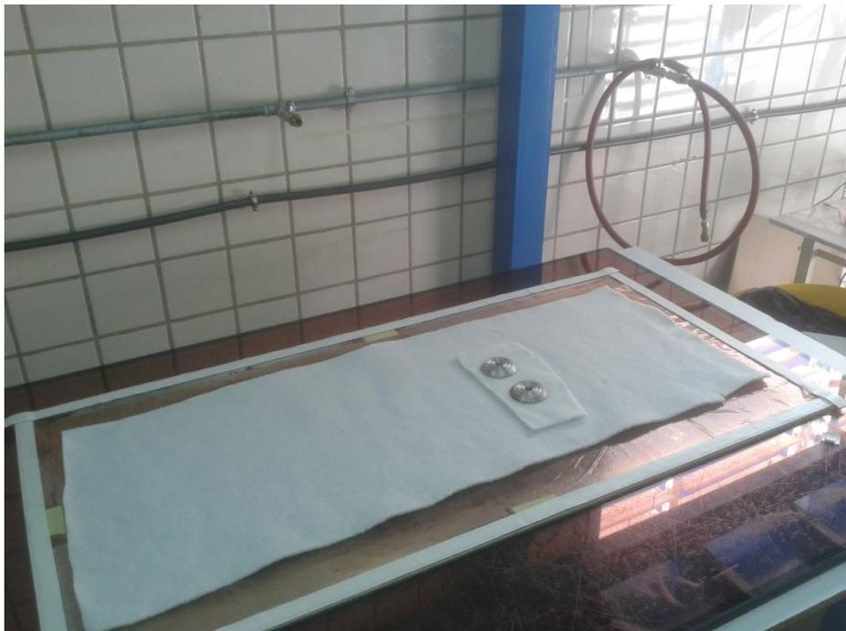
Figura 3.10: Preparación de la *bolsa de vacío*. Paso 3.
