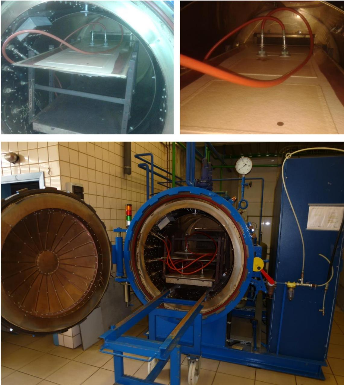
Figura 3.13: Colocación de la *bolsa de vacío* en el autoclave
