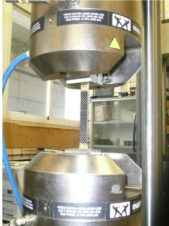
Figura 4.6: Detalle de la colocación de las probetas para los ensayos dinámicos.
