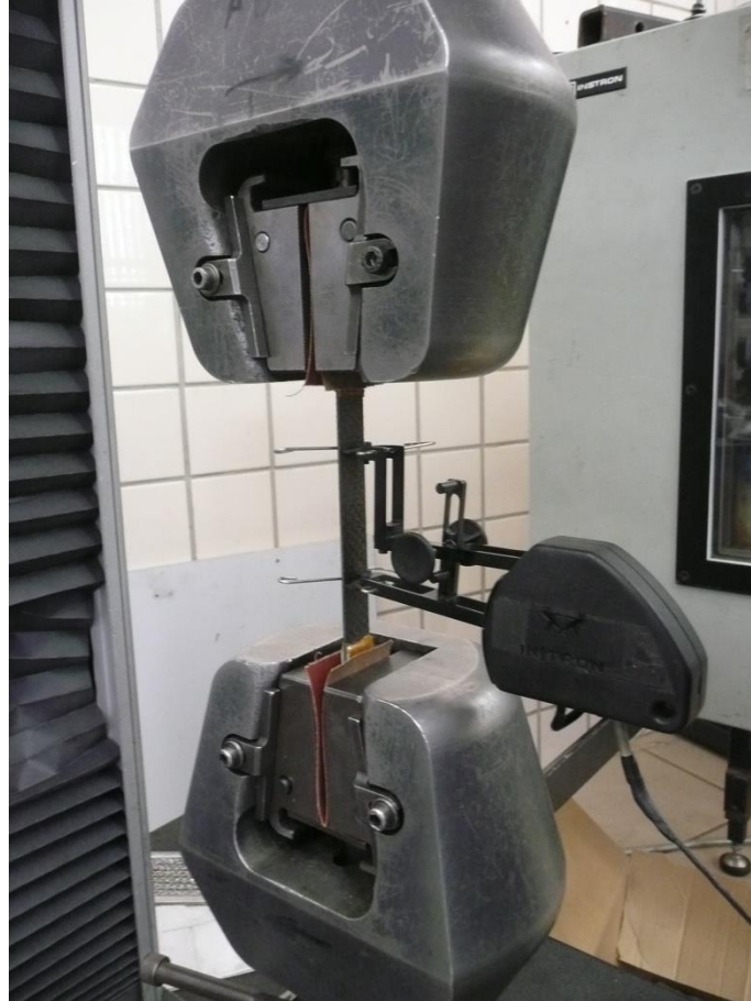
Figura 4.2: Detalle del montaje de los ensayos estáticos. Colocación del espécimen a ensayar y del extensómetro.
