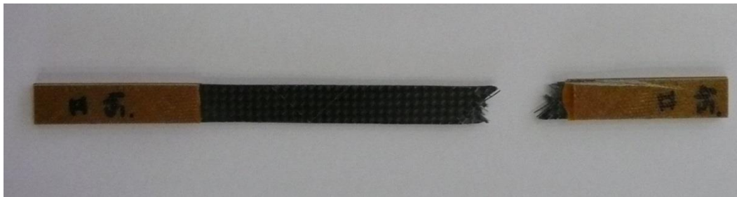
Figura 4.13: Ensayo estático off-axis (especimen 2 del panel 3)
