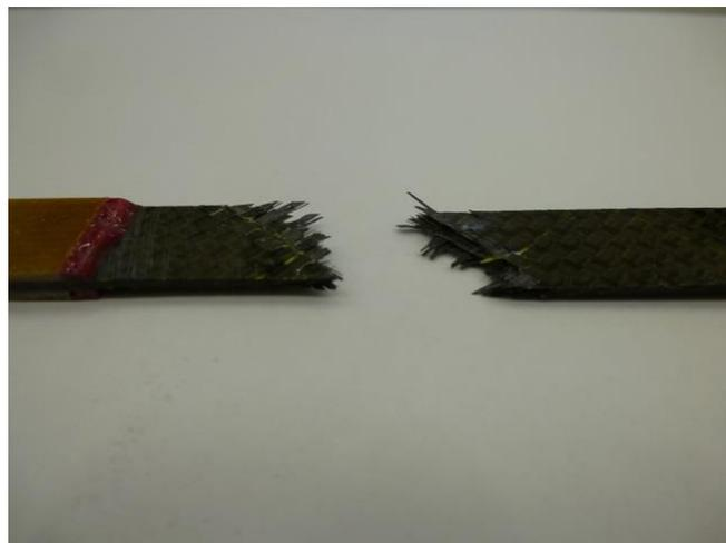
Figura 5.8: Detalle de la zona de rotura. Ensayo estático off-axis. Especímen 2 del panel 4.
