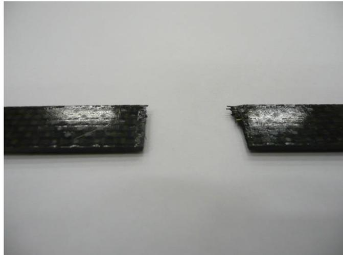
Figura 5.24: Detalle de la rotura de la probeta P0\_12 (95% de carga, 10 Hz)
