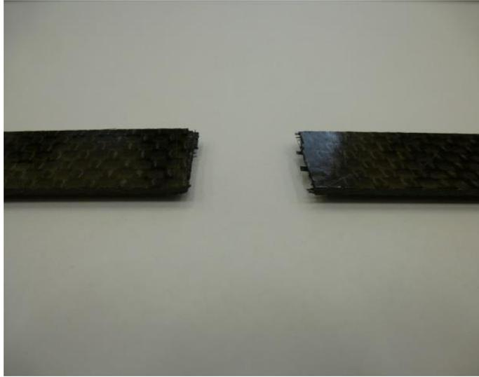
Figura 5.3: Detalle de la zona de rotura. Ensayo estático on-axis. Especímen 1 del panel 2.
