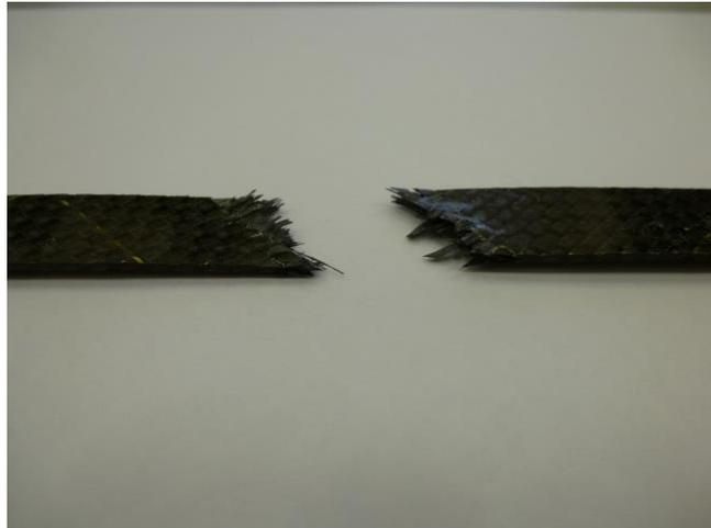
Figura 5.7: Detalle de la zona de rotura. Ensayo estático off-axis. Especímen 1 del panel 4.
