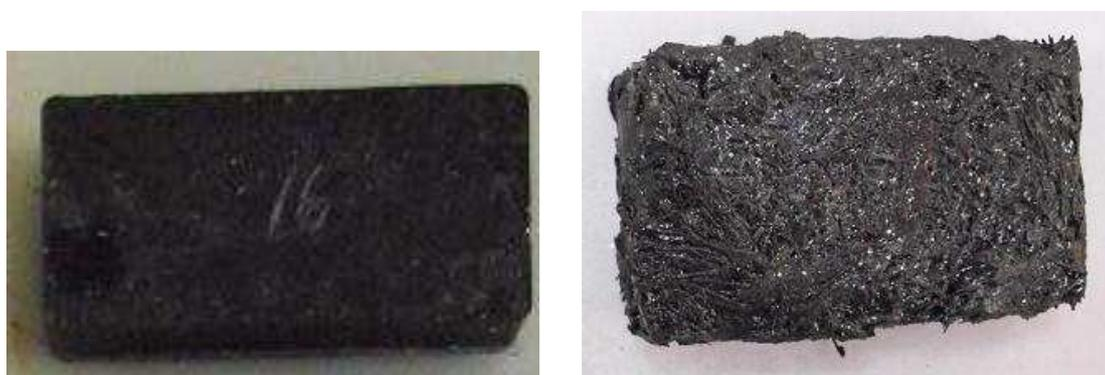
(a) Probeta de emulsión KP y polvo de vidrio. (b) Probeta de emulsión KP y fibra de vidrio.
