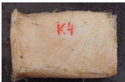
(b) Probeta resina Compodur y fibra de vidrio.
