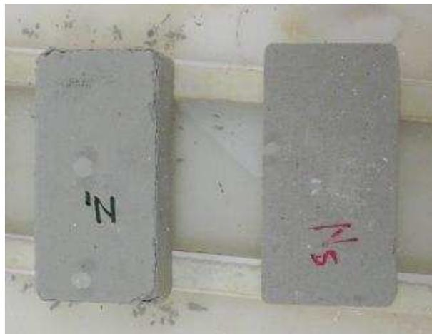
Figura 5.7: Ensayo de absorción.
