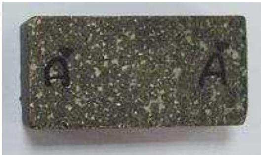
Figura 5.1: Fabricación de probetas de resina epoxy y polvo de vidrio.
