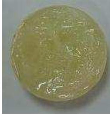
Figura 5.2: Fabricación de probetas de resina epoxy y fibra de vidrio.
